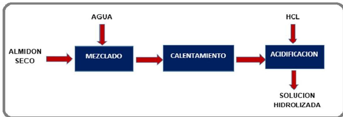
**Figura 4. Proceso de Hidrólisis Ácida para el almidón de yuca.**
