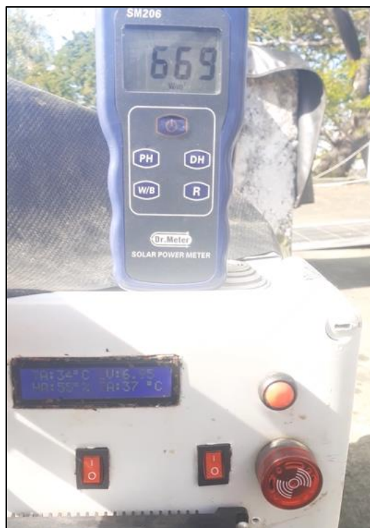
Figura C.17 (b) Medición de la irradiancia cada 3 minutos durante los períodos de exposición solar.
