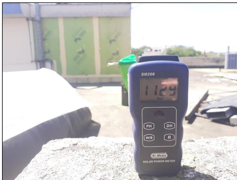
Figura C.16 (a) Medición de la irradiancia cada 3 minutos durante los períodos de exposición solar.
