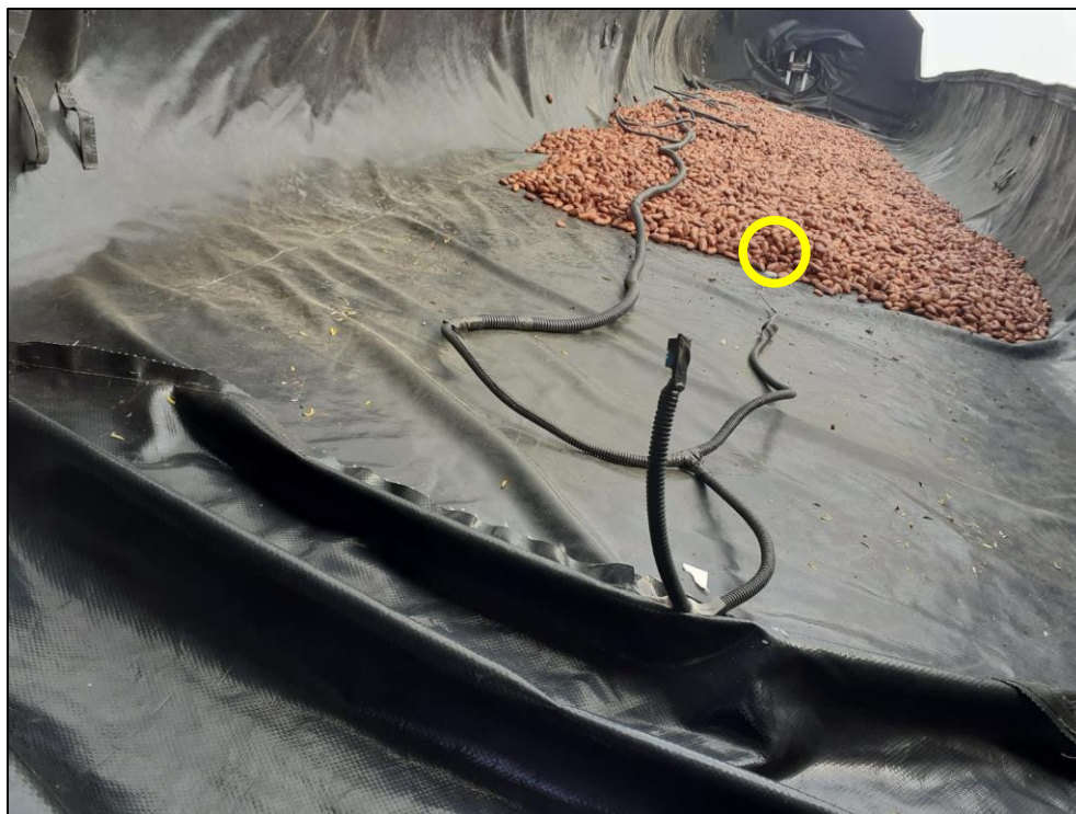
Figura C.9 Sensor de propiedades del aire a la salida y detrás el cableado del sensor de temperatura del grano a 3.0 m
