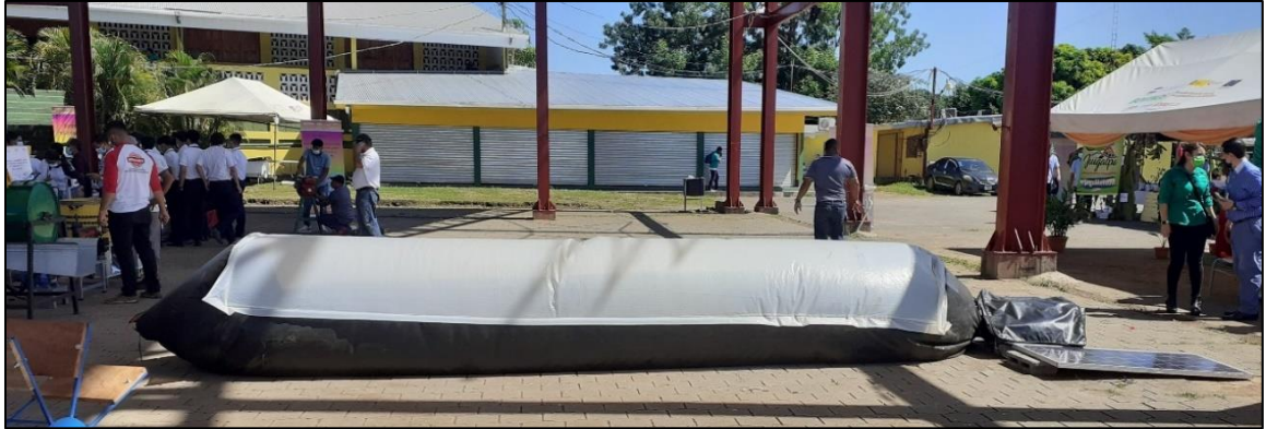
Figura A.3 Vista externa del prototipo de secador solar donde se aprecian sus tres secciones.
