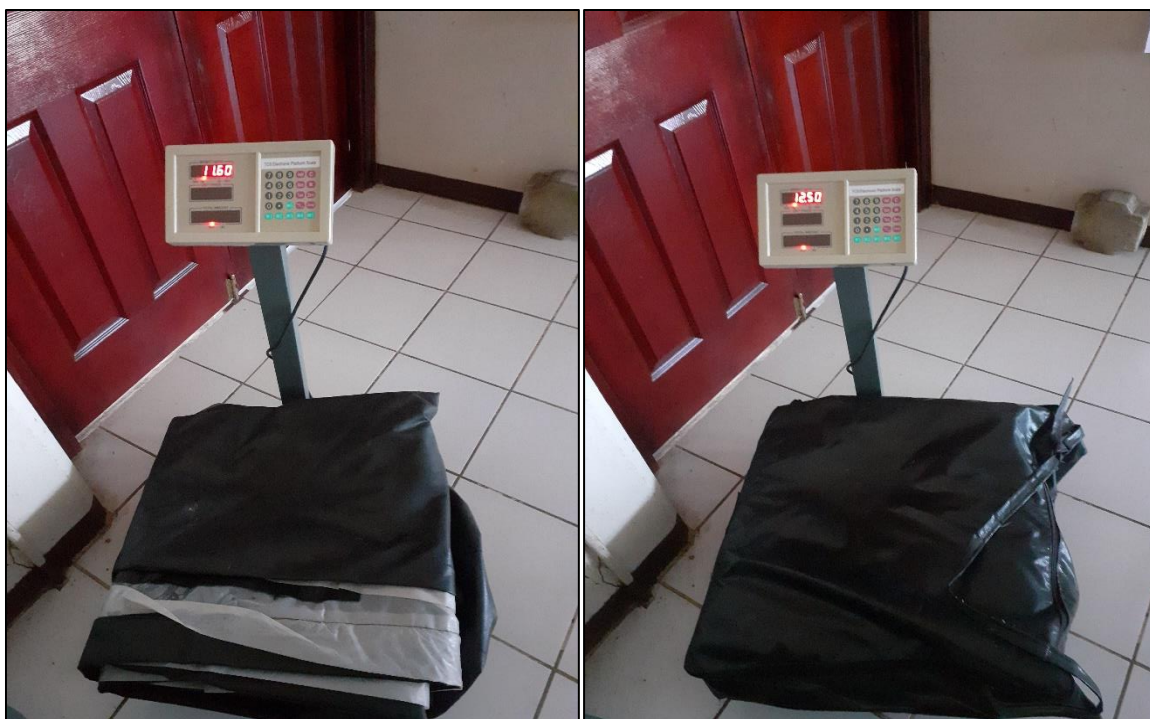
Figura A.12 (a) Medición de la masa del prototipo de secador y (b) del maletín con el prototipo de secador en su interior.
