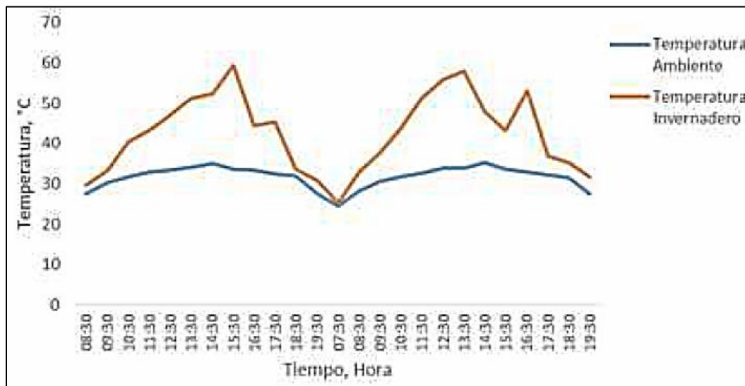
Figura 3.13 Comparación de la temperatura del aire dentro y fuera del secador como función de la hora local. Tomado de López & Chávez (2018), figura 3.
