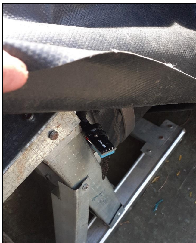
Figura C.6 Sensor de propiedades del aire ubicado externamente a la entrada.
