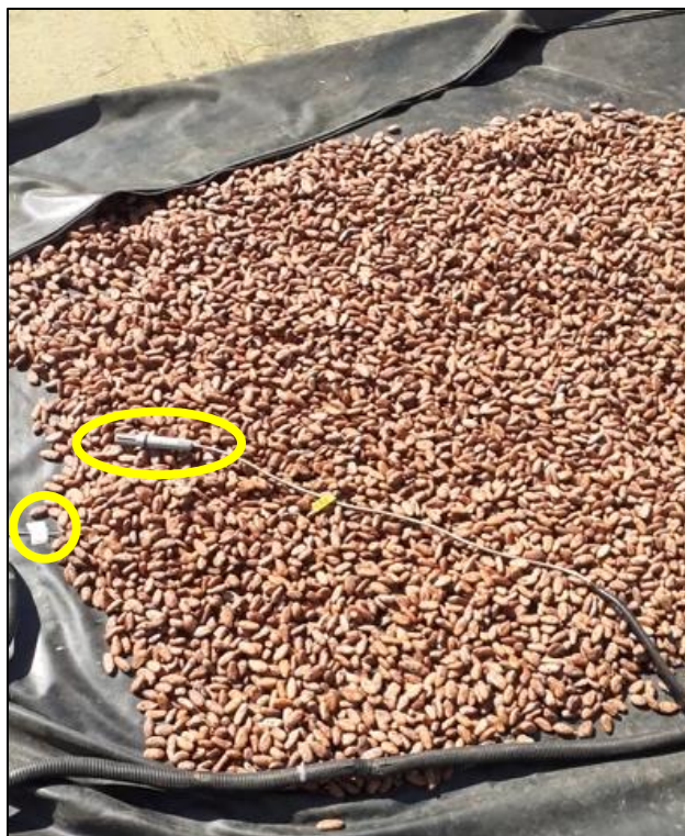
Figura C.7 Sensor de temperatura del aire ubicado a 0.0 m de la entrada. Dentro del lecho de granos se encuentra el sensor de temperatura de grano a 0.0 m.
