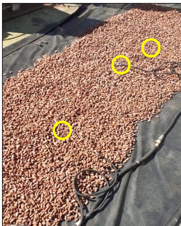
Figura C.8 Sensor de temperatura del grano a 1 m y sensor de propiedades del aire a 1.5 m
