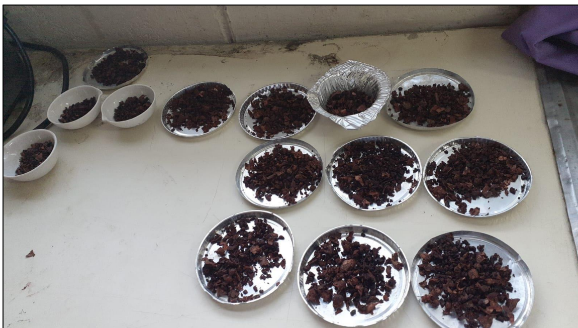
Figura C.11 Muestras de cacao para determinar la humedad del lecho empleando el método al horno de la norma internacional ISO-2451:2017.
