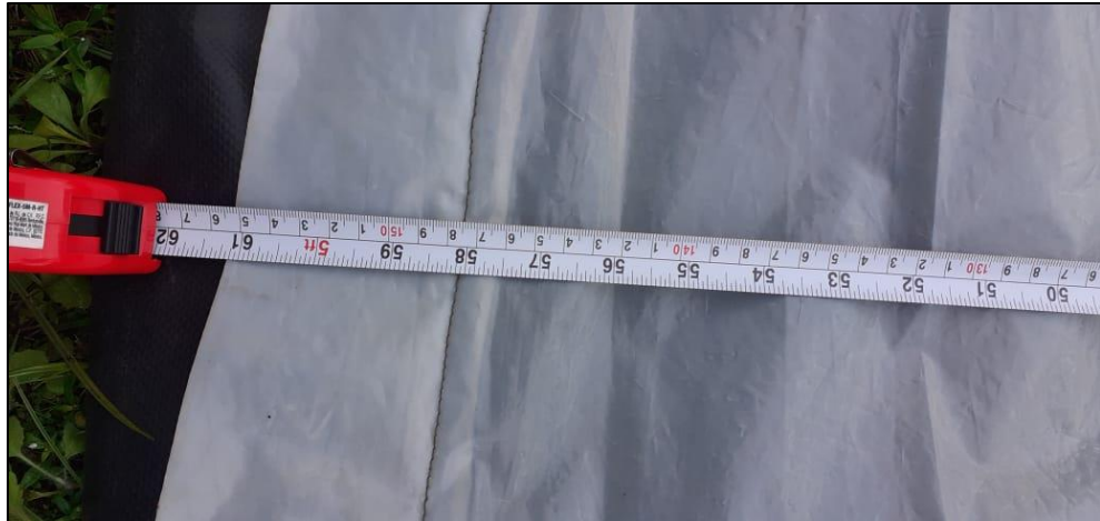
Figura A.10 Medición del ancho de la cubierta del prototipo de secador.
