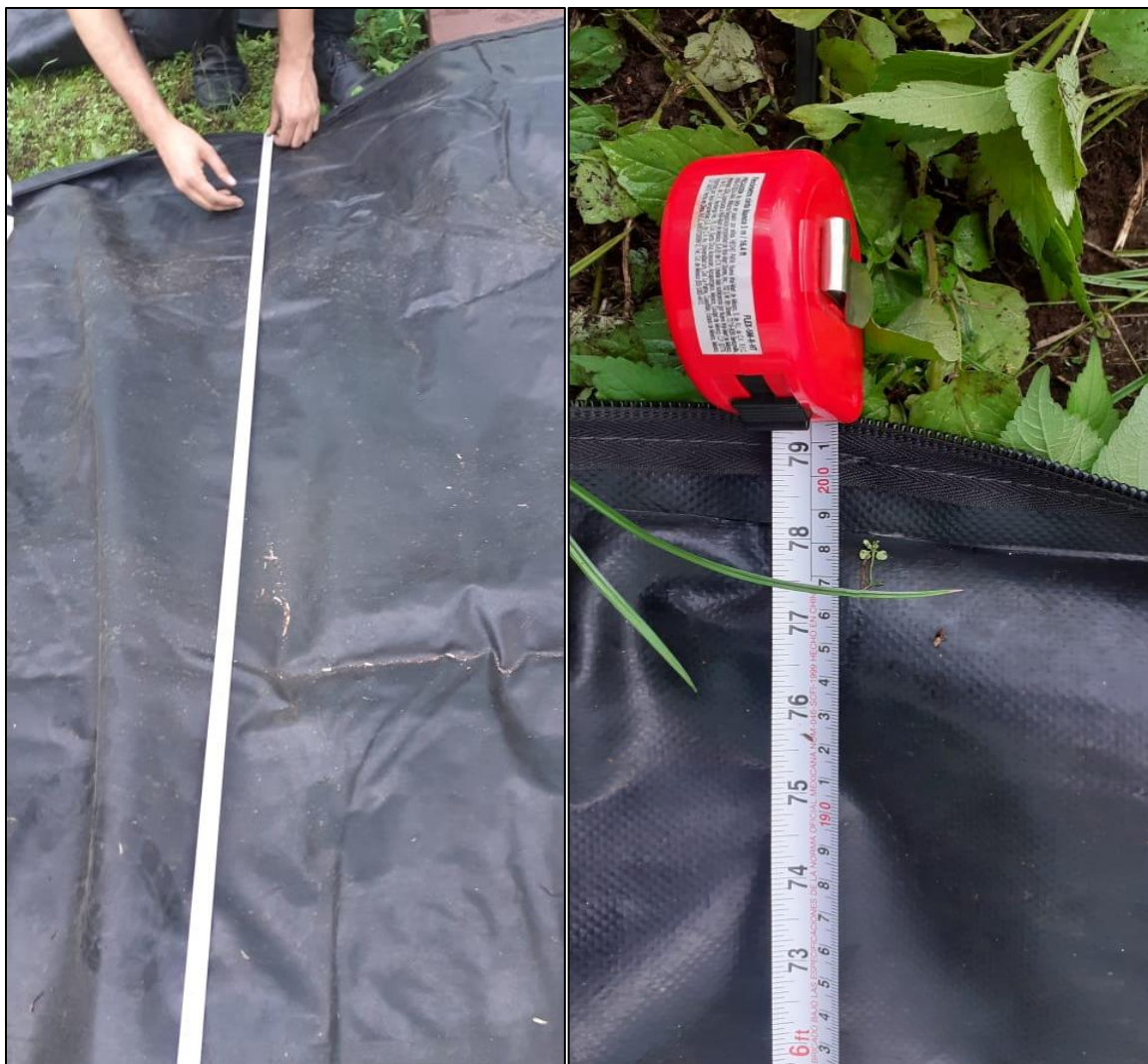
Figura A.8 Medición del ancho del área de secado del prototipo de secador solar.
