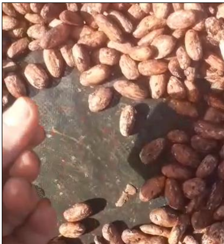
Figura C.12 Película de humedad en el fondo de prototipo de secador observada al finalizar el período de exposición solar en el primer y segundo día de secado.
