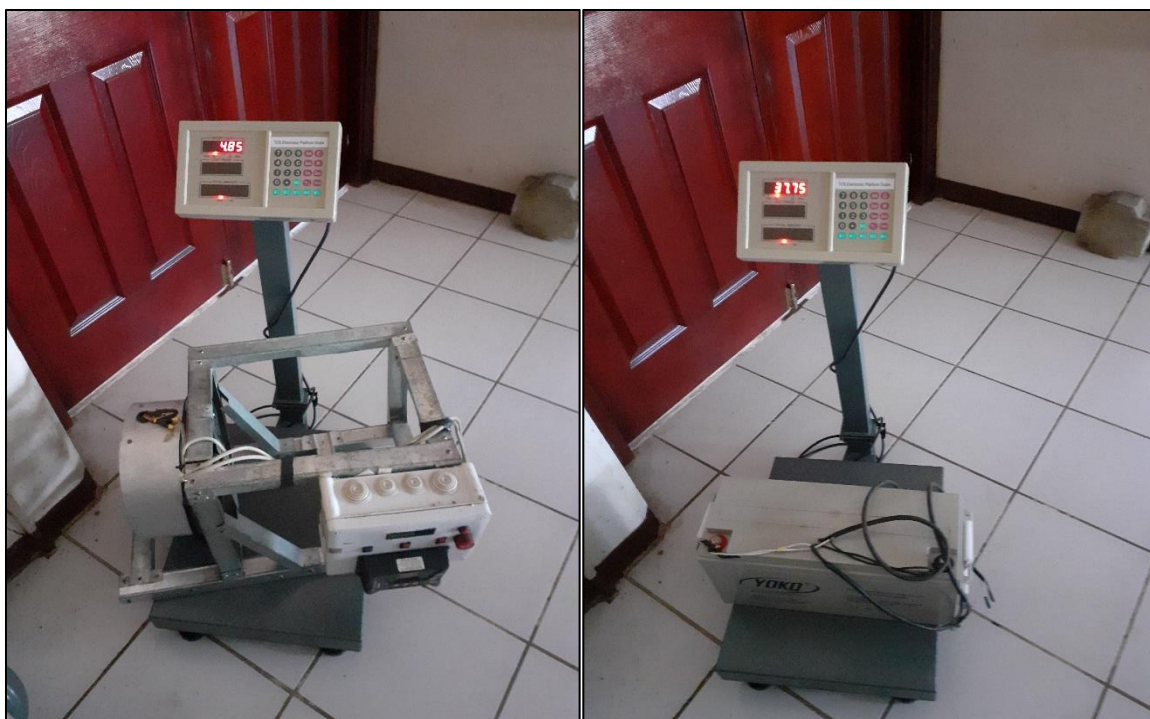
Figura A.13 (a) Medición de la masa de la estructura metálica y (b) de la batería.
