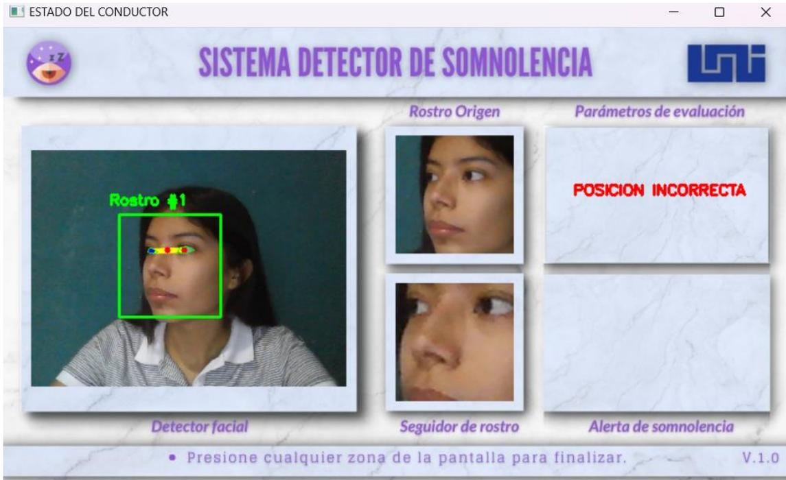
Fig. 52 Alarma de posición incorrecta al girar el rostro hacia la derecha. Elaboración propia.
