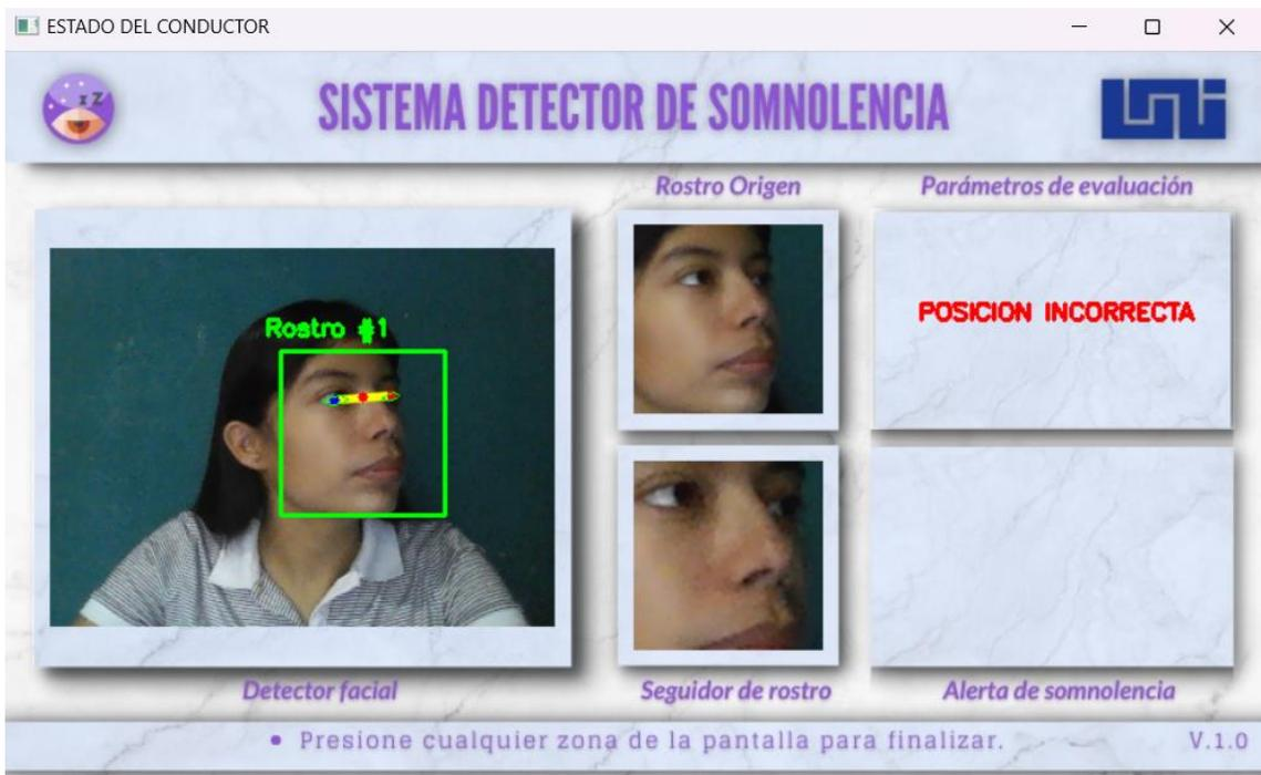
Fig. 53 Alarma de posición incorrecta al girar el rostro hacia la izquierda. Elaboración propia.
