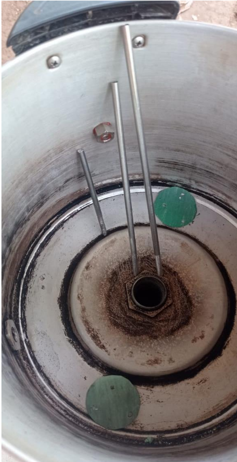
Construcción de electrodos de acero inoxidable Fuente: autoría propia
