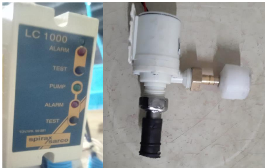
Controlador de nivel LC 1000 y bomba de circulación de agua caliente Fuente: autoría propia
