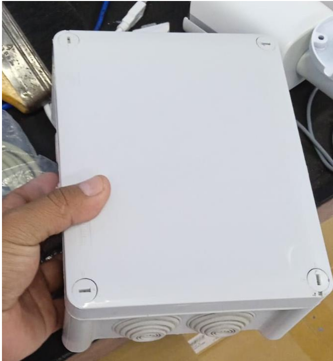
Caja plexo IP65, para panel de dispositivos de control Fuente: autoría propia
