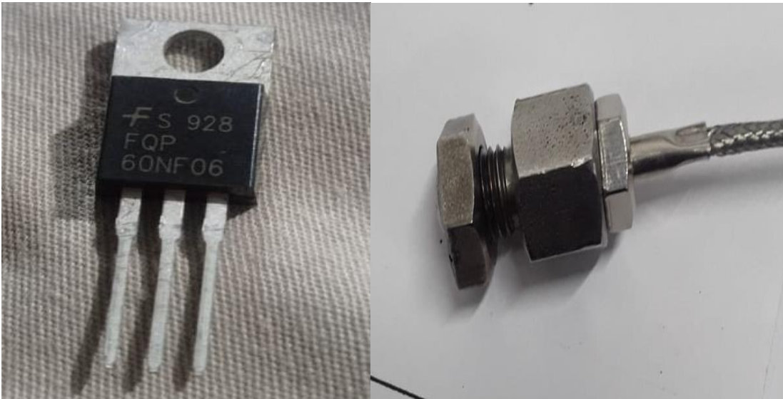
Transistor para conmutación PWM y termopozo para termocupla. Fuente: autoría propia
