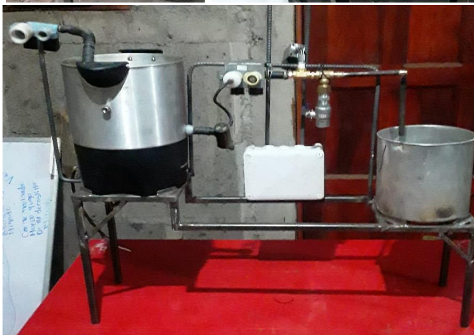
Pruebas de montaje tanque, esterilizador y tubería del prototipo Fuente: autoría propia
