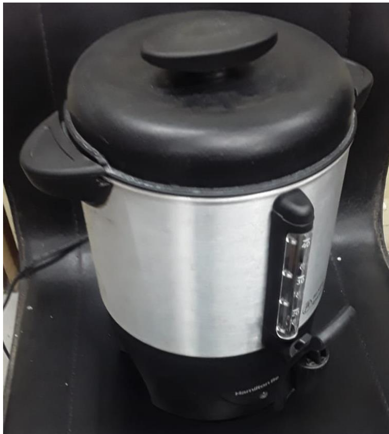
Cafetera para emular el tanque de agua caliente. Fuente: autoría propia
