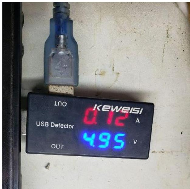
**Figura 8.7 Tester USB (consumo del Circuito completo de Arduino)**
