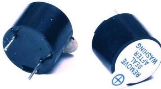
**Figura 3.33 Buzzer activo de 4 a 7 VDC**
