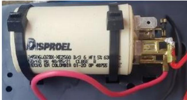
**Figura 5.41 Capacitor de carga de 6uF 5% 630vdc 50/60 Hz**
