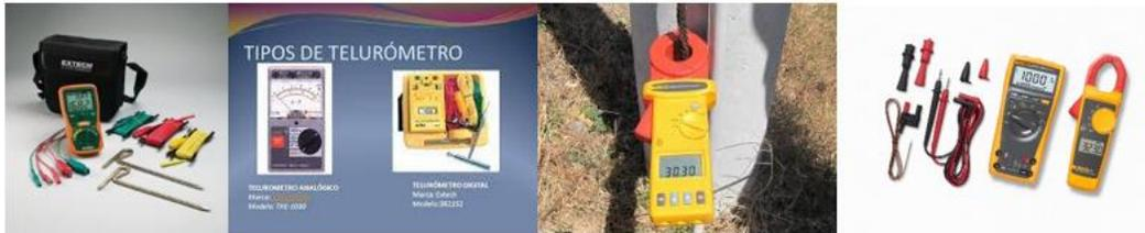
Figura No. 13 Tipos de Telurómetros y Medición Convencional
