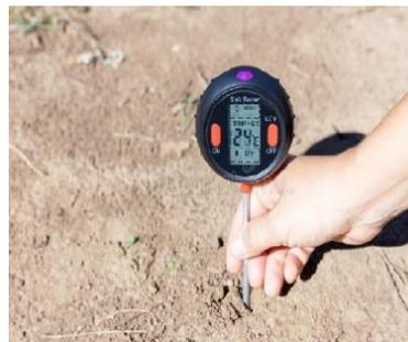
Figura No. 9 Medición de Temperatura del Suelo
