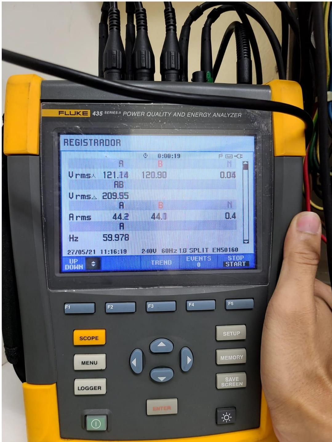
Instalación de analizador de redes fluke en centro de caga de laboratorio.
