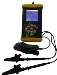
**Fig. 96.** Analizador monofásico portátil Nanovip 2
