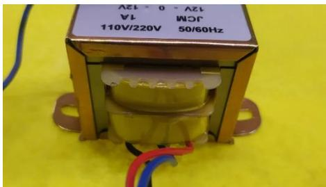
**Fig. 41.** Transformador magnético con entrada 110/220 salida 24 V-1A
