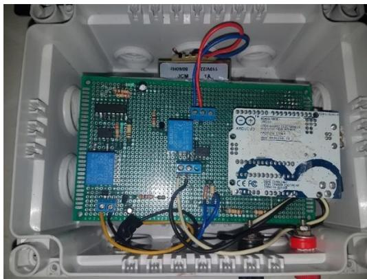
**Fig. 72.** Circuito Acondicionador soldado en baquelita perforada
