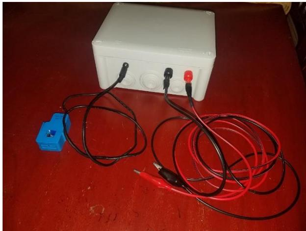
**Fig. 74.** Tarjeta acondicionadora y circuito de acondicionamiento montando en caja plexo PVC.
