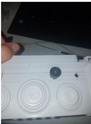
**Fig. 73.** Perforación de agujero para insertar conectar macho tipo banana para las puntas de prueba.
