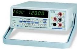
**Fig. 5.** Multímetro digital de laboratorio, instrumento de medida electrónico
