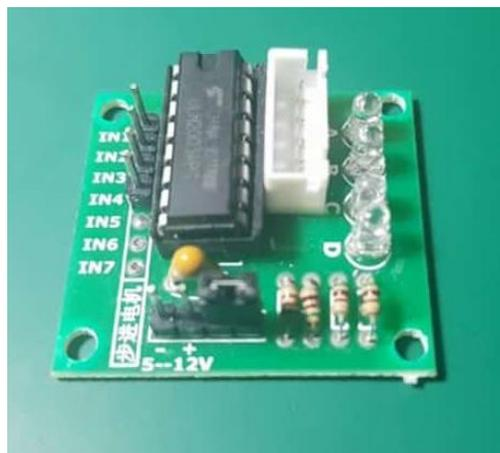
Figura 33 Tarjeta controladora ULN2003.
