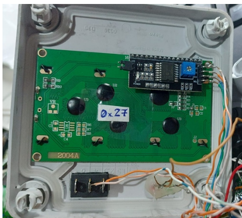
Imagen 48 – Pantalla LCD instalada en tapa caja contenedora.
