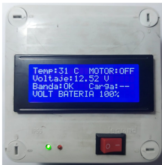
Imagen 42 – Condición auto apagado, simulación de batería al 100% de capacidad y banda OK.
