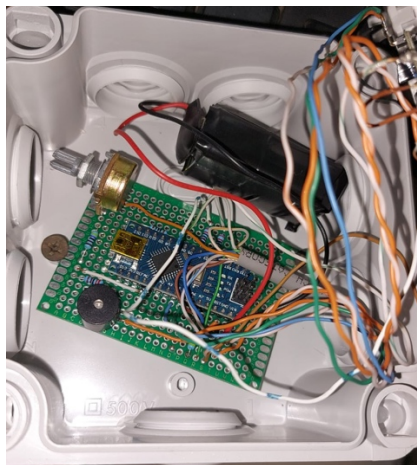
Imagen 47 – Placa Arduino nano en tarjeta perforada y batería dentro de caja contenedora.
