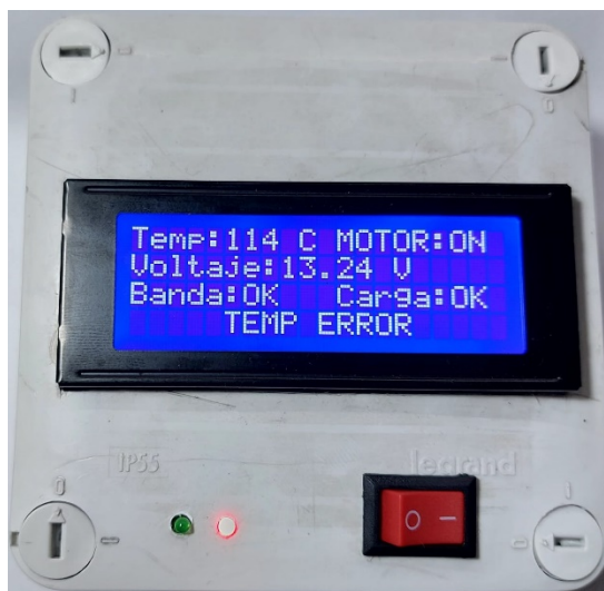
Imagen 46 – Condición auto encendido, simulación de batería cargando, banda OK y temperatura por encima del umbral.
