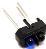
Imagen 13 – Sensor óptico reflexivo. (Rebeca, 2020)
