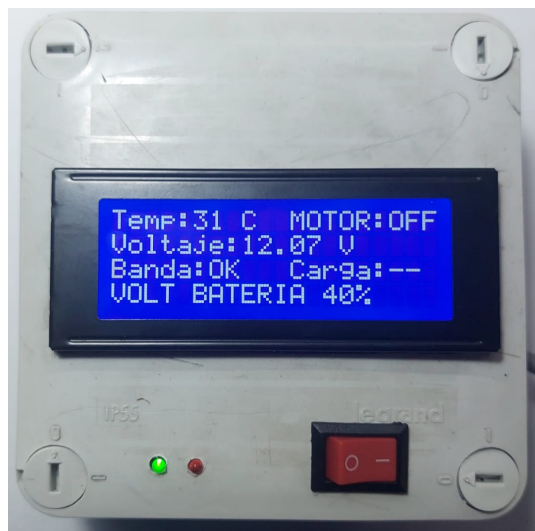
Imagen 39 – Condición auto apagado, simulación de batería al 40% de capacidad y banda OK.
