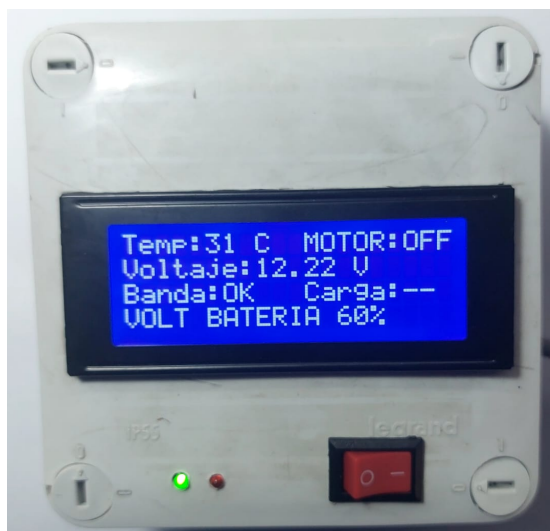
Imagen 40 – Condición auto apagado, simulación de batería al 60% de capacidad y banda OK.
