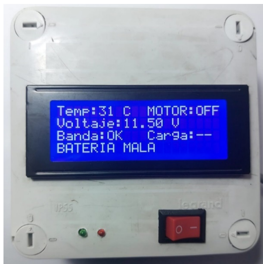
Imagen 38 – Condición auto apagado, simulación de batería al bajo nivel de voltaje y banda OK.
