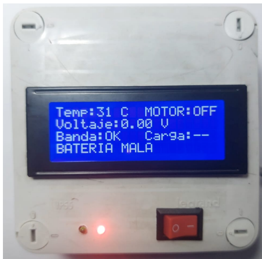
Imagen 37 – Condición auto apagado, simulación de batería descargada totalmente.
