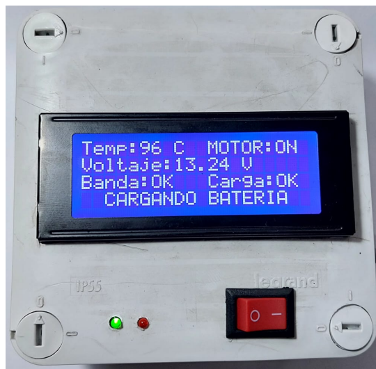
Imagen 54 – Condición auto encendido, simulación de batería cargando, banda OK y temperatura OK.
