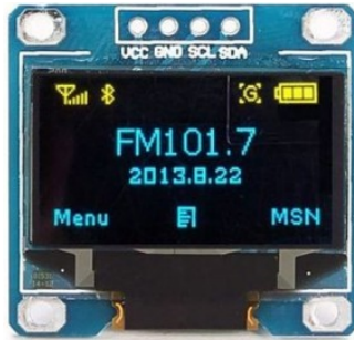
Imagen 17 – Pantalla LCD OLED 2 COLORES 0.96". (Arduino Nicaragua, Mikrotroica., 2019)
