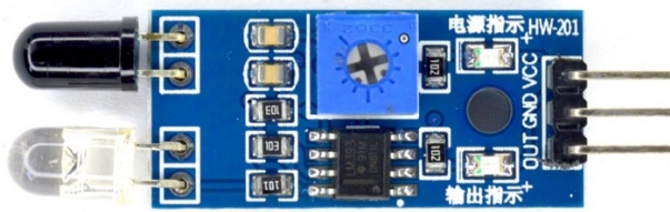
Imagen 22 - Sensor infrarrojo HW201. (Arduino Nicaragua, Mikrotonica, 2019)
