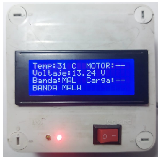
Imagen 44 – Condición auto encendido, simulación momento justo en que se rompe o sale de lugar la banda.
