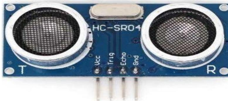
*Figura 18 Sensor Ultrasónico (electronicamade, 2020)*
