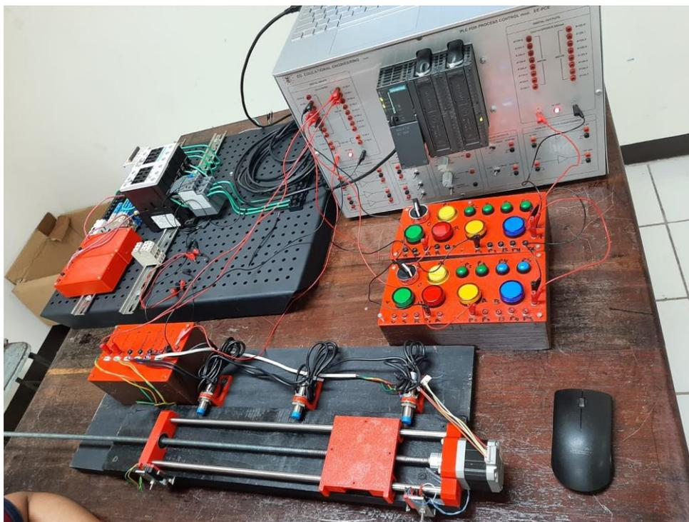
Figura 64. Dispositivos implementados y conectados al PLC
