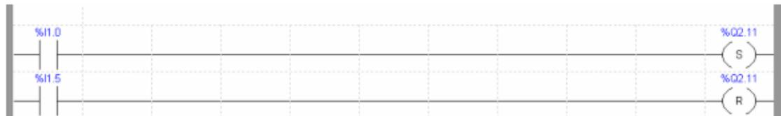
Se desea hacer un enclavamiento eléctrico, de manera que, con dos pulsadores, uno de marcha (E124.0) y otro de paro ((E124.1), se active o se desactive un motor (A124.0). Programe el bloque OB1 utilizando instrucciones SET, RESET y SR en SIMATIC STEP 7 y compruebe su funcionamiento utilizando el simulador PLC SIM.
