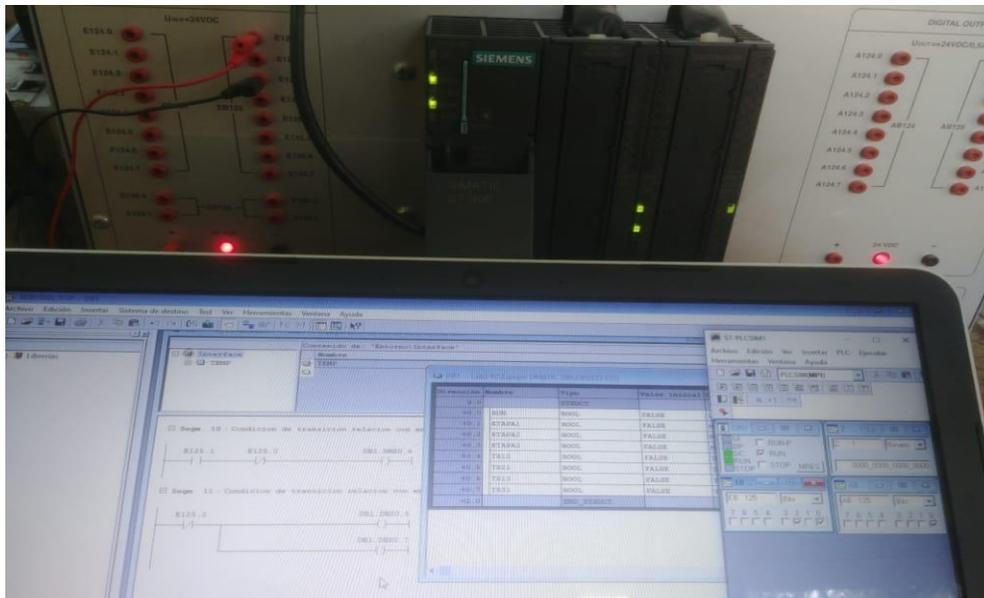
Figura 32. Programa en ejecución entrada y salida activadas
