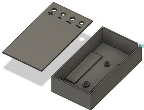
Figura 43 Modelo de carcasa para SSR. Fuente: Autor
