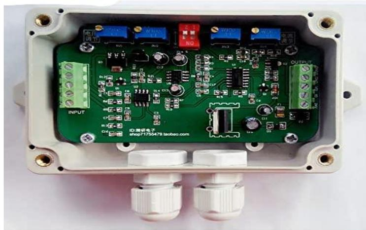
Figura 46. Transmisor de celda de carga JY-60
