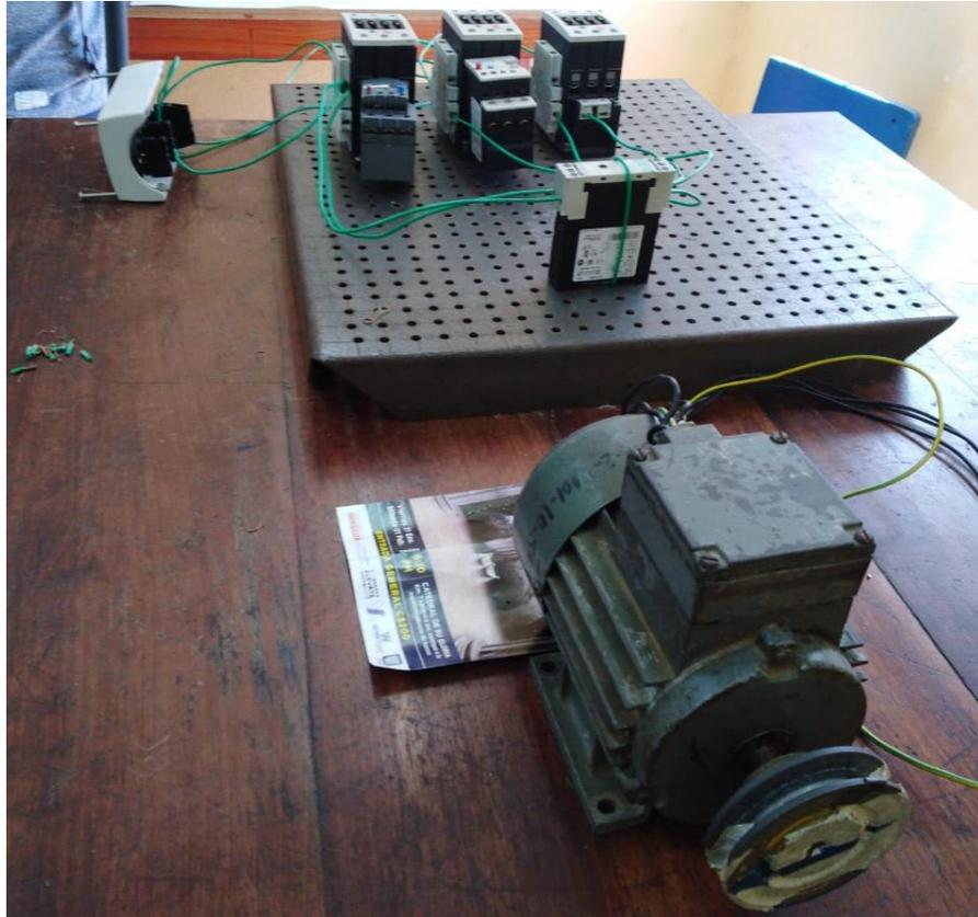
Figura 21. Practica de laboratorio de arranque de motor basado en lógica cableada
