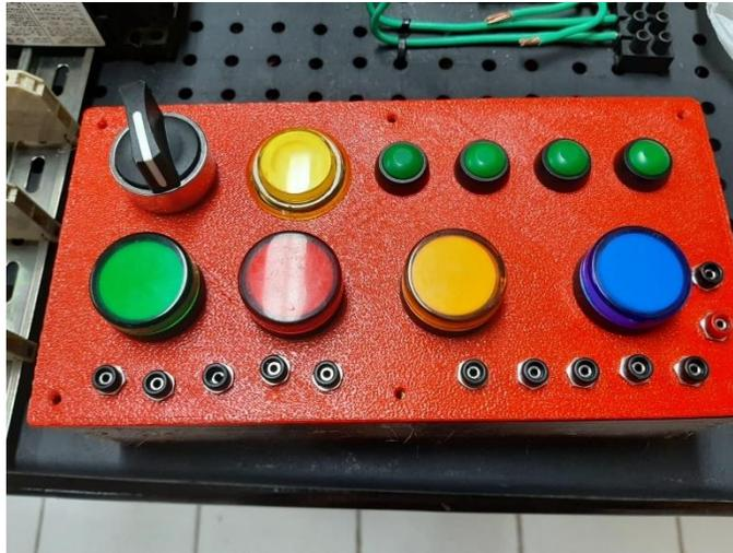
Figura 59. Panel de entradas salidas implementado
