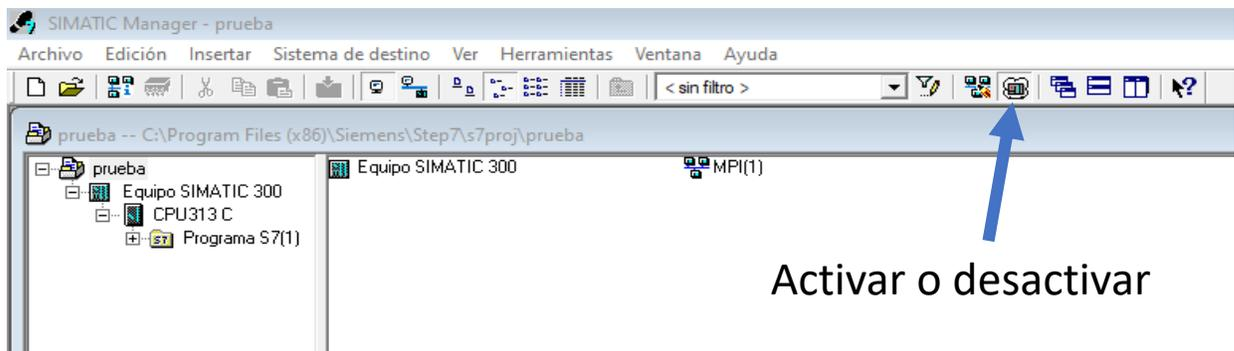
Al activar el simular se abrirá una nueva ventana con el PLC Virtual para la simulación, de inicio solo contiene la CPU genérica la cual presenta 3 estado, RUN-P, RUN, STOP de operación, antes de cargar el programa desde el entorno de programación se debe asegurar que el PLC este en STOP, Una vez configurado para iniciar la simulación, bastara con dar clic en RUN para que inicie la simulación.
