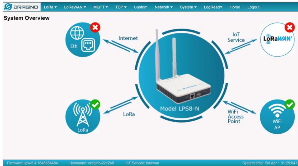
Figura 21. Vista general del sistema Dragino [Autor].
