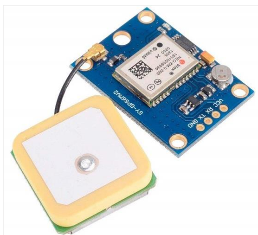
Figura 10. Módulo GPS GY-NEO6MV2 (Amazon, 2019).
