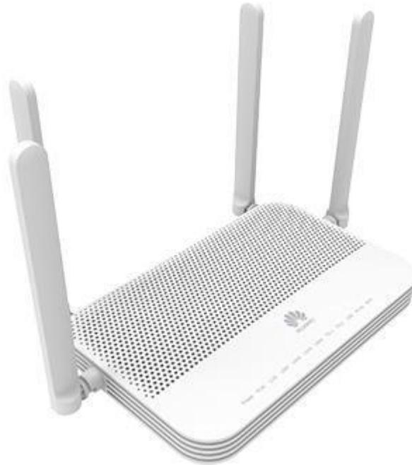
**Figura 32. ONT EG8245W5-6T de la marca Huawei. [15]**
