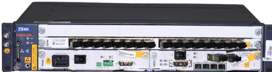
Figura 16. OLT marca ZTE modelo ZXA10 C320, equipo a utilizar en Villa Rafaela Padilla. [19]
