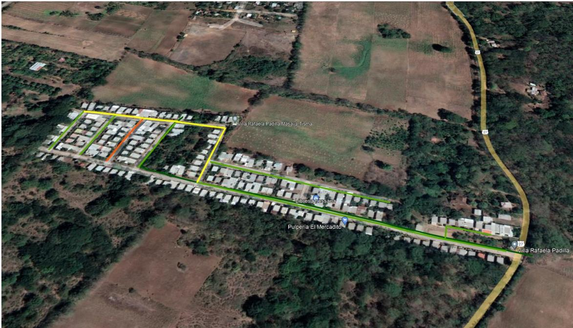
**Figura 10. Trazado de instalación de cable de fibra óptica.**
