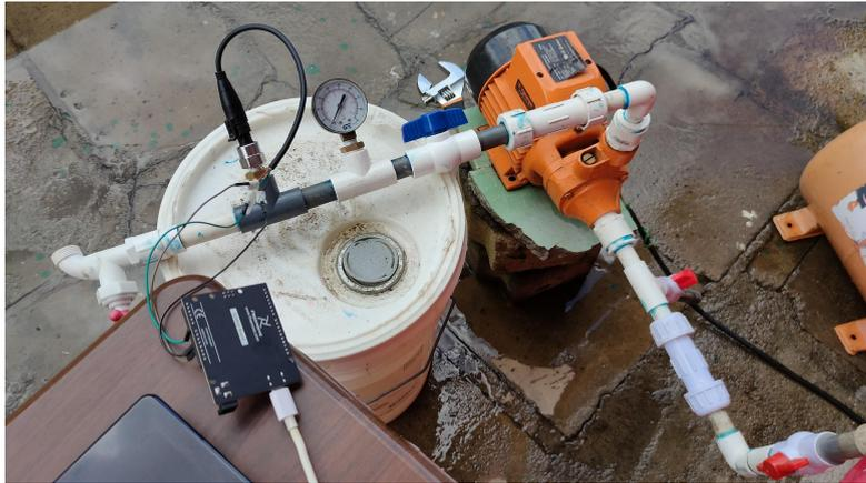
**Figura 6.12.** Conexión de la etapa de medición
