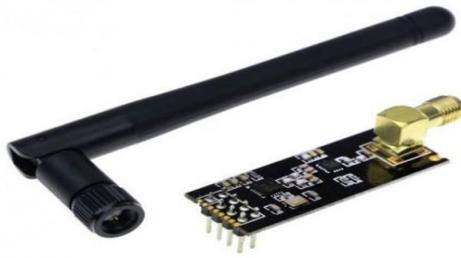
**Figura 1.4.** Módulo transceptor NRF24L01
