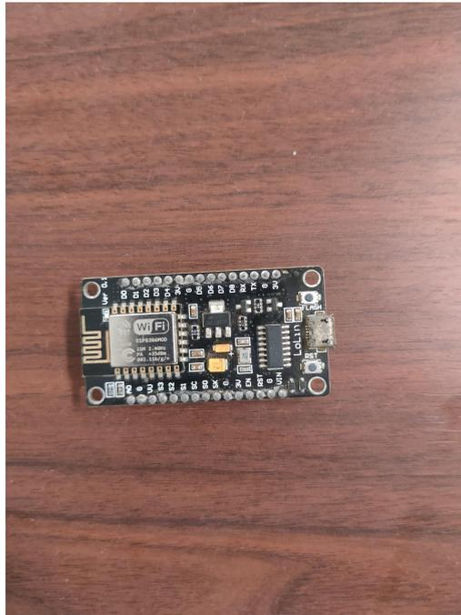
**Figura 3.2.** Módulo ESP8266
