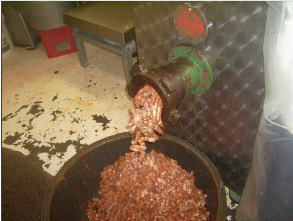
**Fig. 7.1.10.1 Molino para carne con óxido y pintura desgastada**
