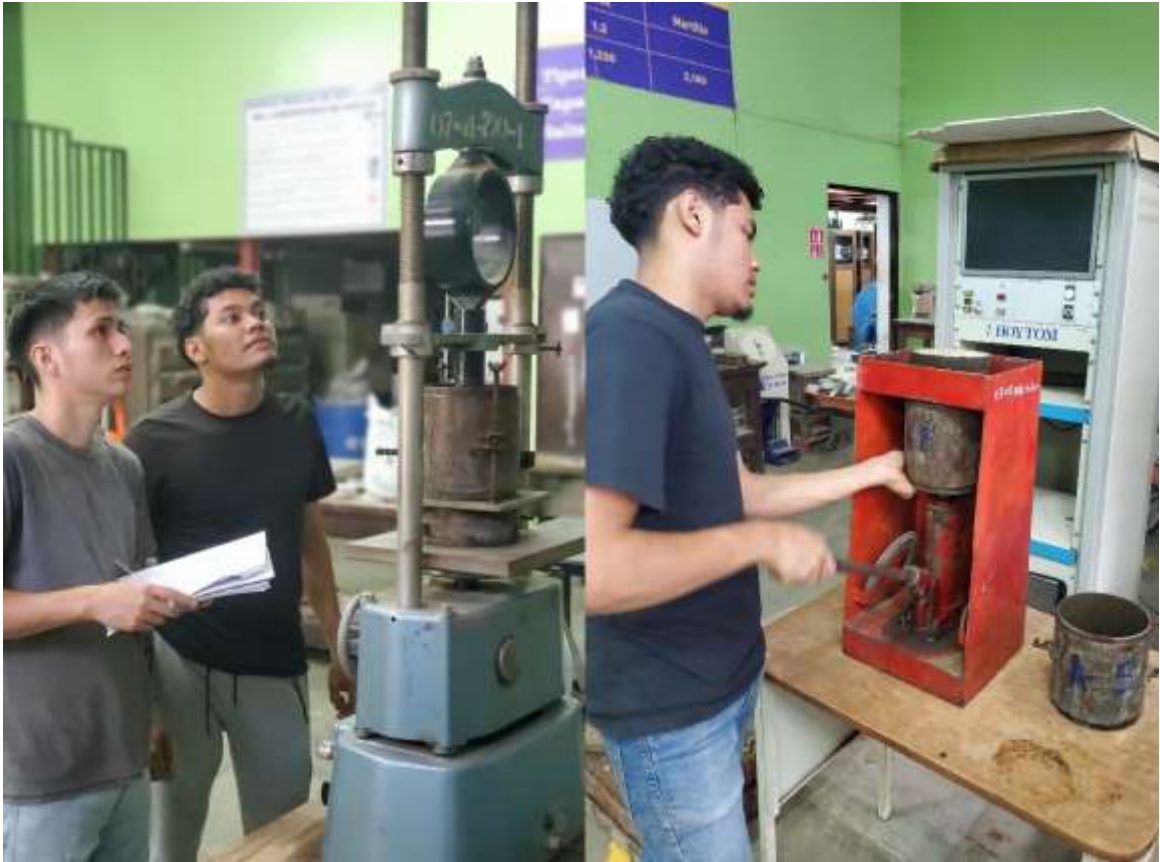
Figura 52. Ensayo de CBR (Penetración, Extracción de núcleo).
