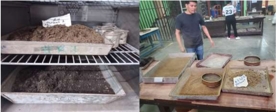
Figura 48. Ensaye Proctor estándar y modificado (secado y tamizado).
