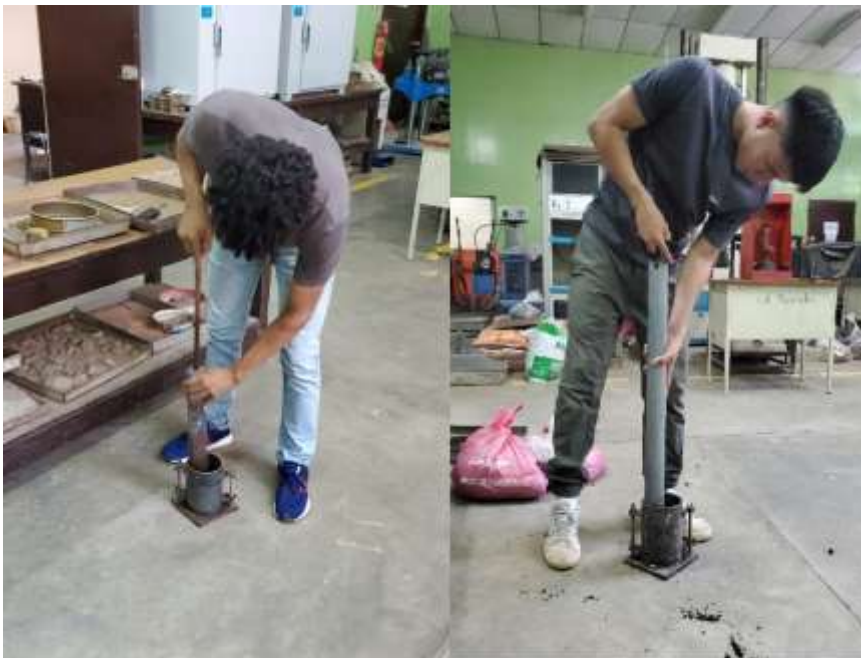
Figura 49. Ensaye Proctor estándar y modificado (compactación).
