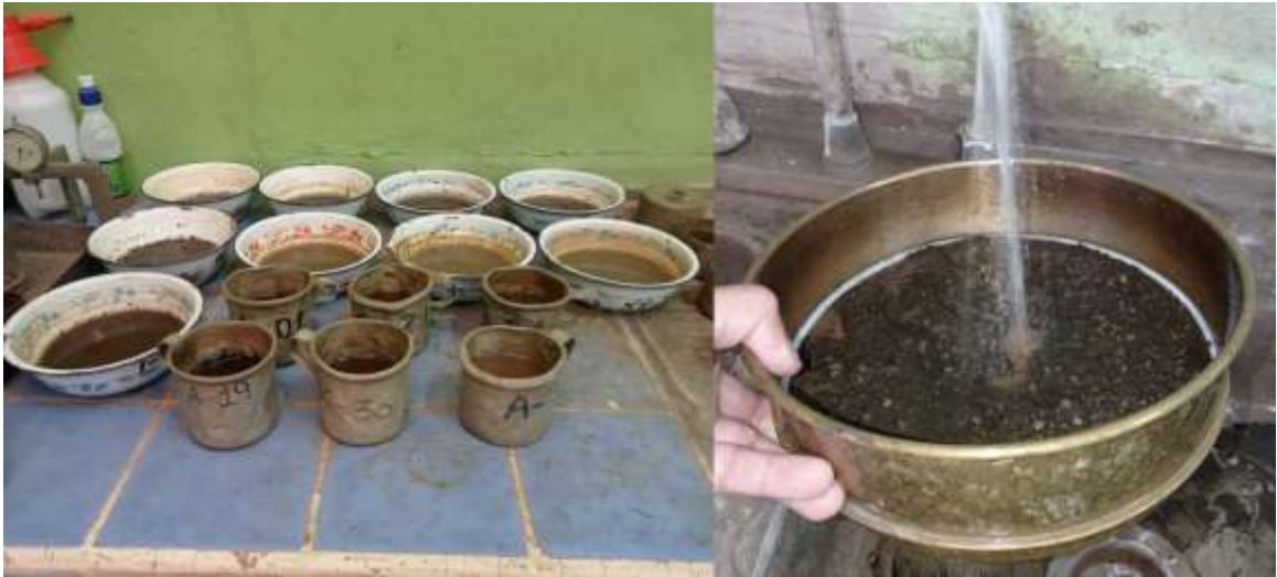
Figura 46. Ensaye de granulometría (Saturación, Lavado).
