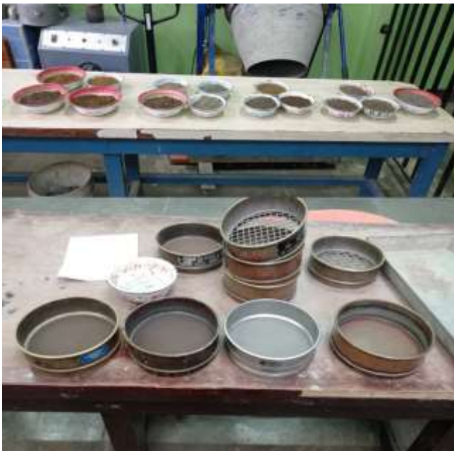
Figura 45. Ensaye de granulometría.
