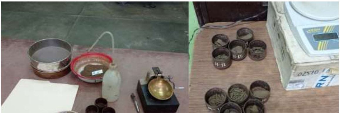
Figura 47. Ensaye de estados de consistencia (Limite líquido, Limite plástico).
