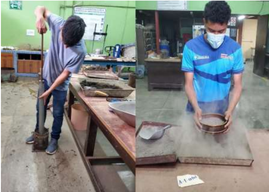
Figura 50. Ensaye de CBR (Elaboración de especímenes, Tamizado y Compactación).
