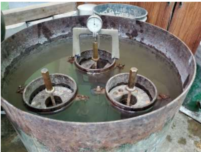
Figura 51. Ensaye de CBR (Inmersión, Toma de lectura de expansión).
