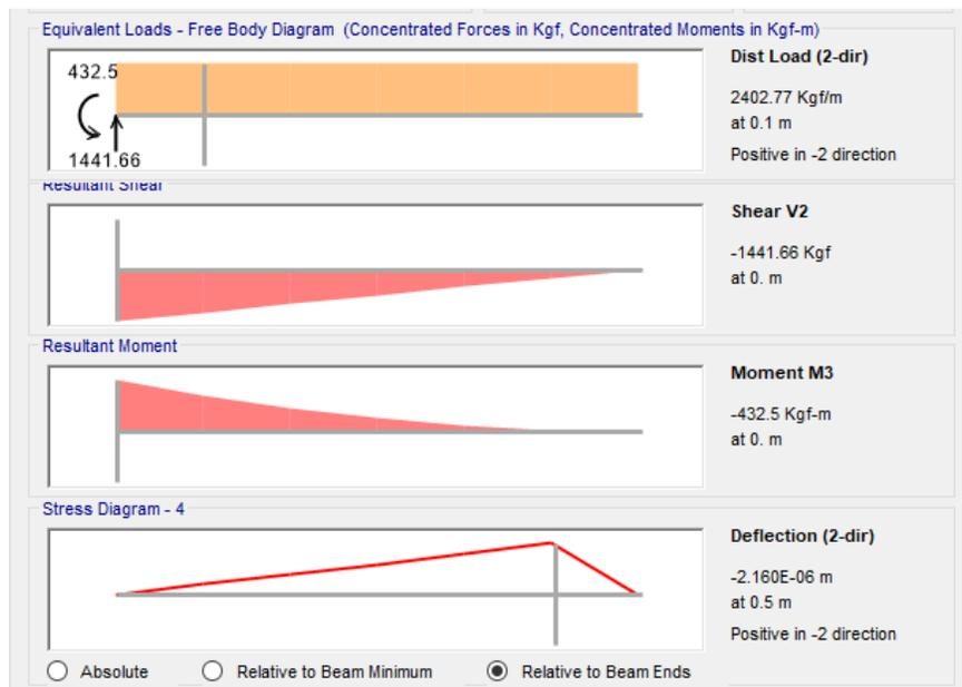
Ilustración 58 Diagrama de Cortantes y Momentos Máximos en la Cimentación, fuente propia.
