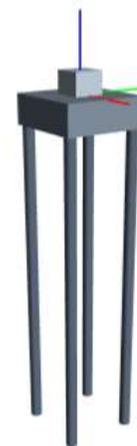
Ilustración 55 Nomenclatura para el dimensionamiento de cimentación a base de pilotes en SAP 2000 y modelo tridimensional de zapata aislada sobre pilotes tomando en cuenta la ISE
