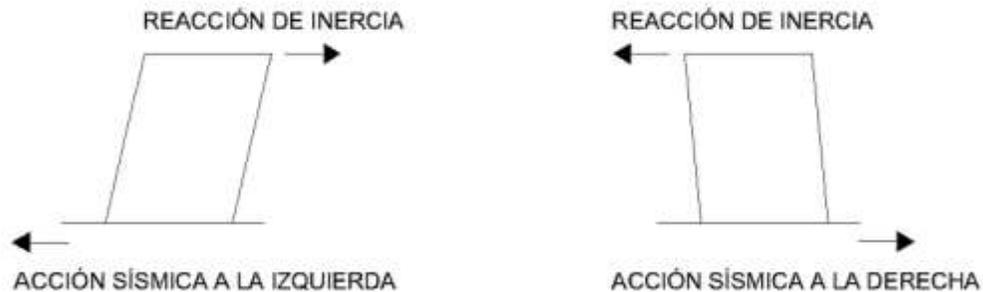
*Ilustración 3 Oscilaciones horizontales de un edificio (Jiménez, 2018)*
