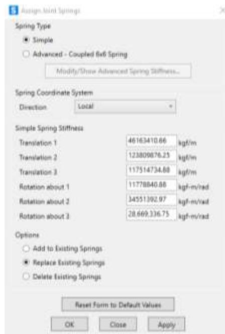
Ilustración 38 Ingreso de Rigideces y amortiguamientos para los resortes en el centro del modelo, fuente propia.
