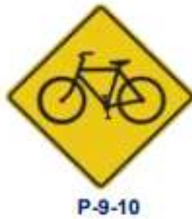
Figura 40: Señal preventiva “Circulación de bicicletas” (P-9-10)
