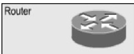
Como dispositivo a nivel de capa 3, está incluido en la red un router Linksys Modelo BEFSR41 Ver. 2 EtherFast Cable/DSL con 4 10/100. Al trabajar en la Capa 3 el router puede tomar decisiones basadas en grupos de direcciones de red (Clases) en contraposición con las direcciones MAC de Capa 2 individuales.
