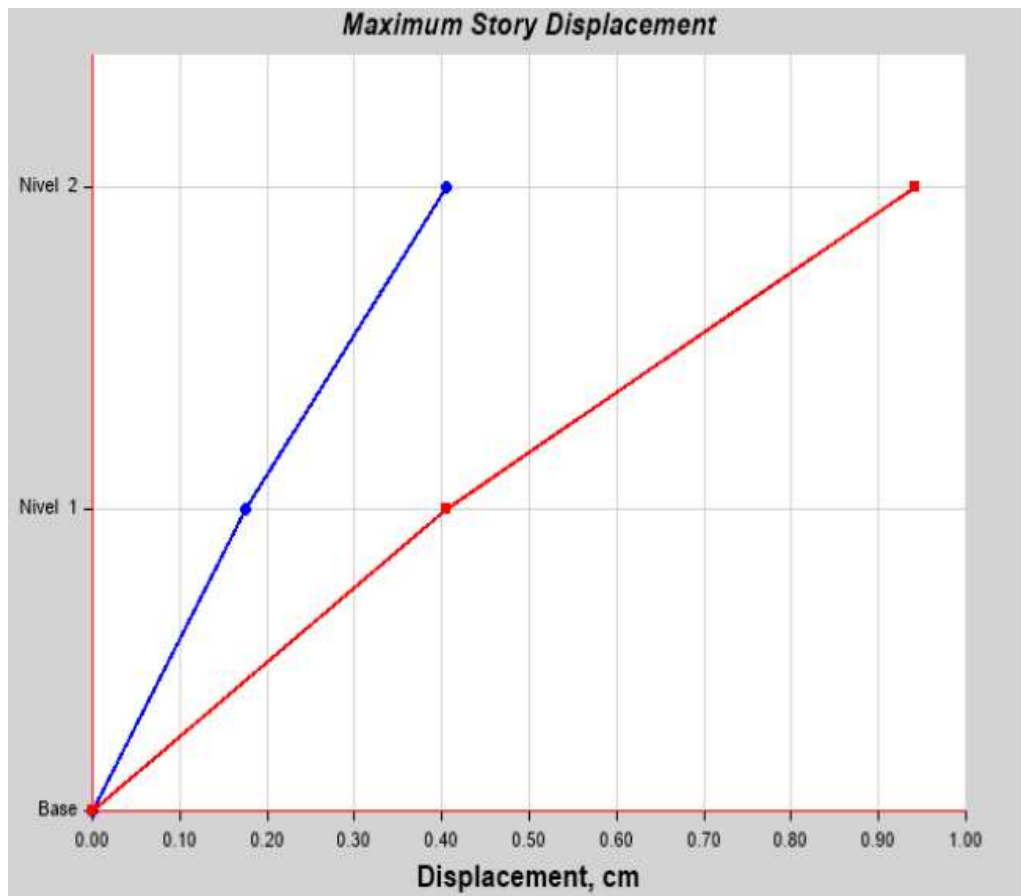
Ilustración 49: Desplazamientos máximos de piso en 4 (1) (DME)
