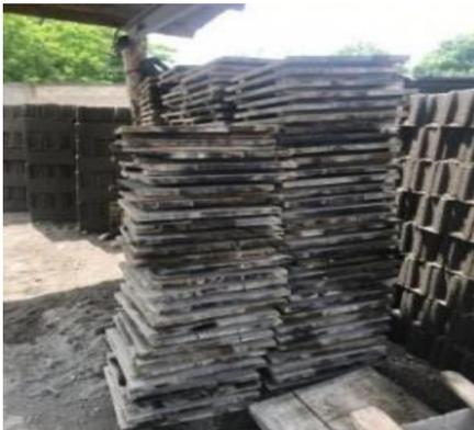
Son tablas de maderas que se utilizan para trasladar los bloques de la máquina al lugar de secado y almacenamiento.
