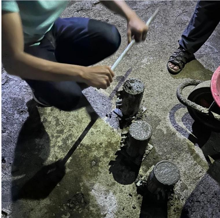
Fotografía 3 Primer grupo de probetas fabricadas con diseño de mezcla preliminar
