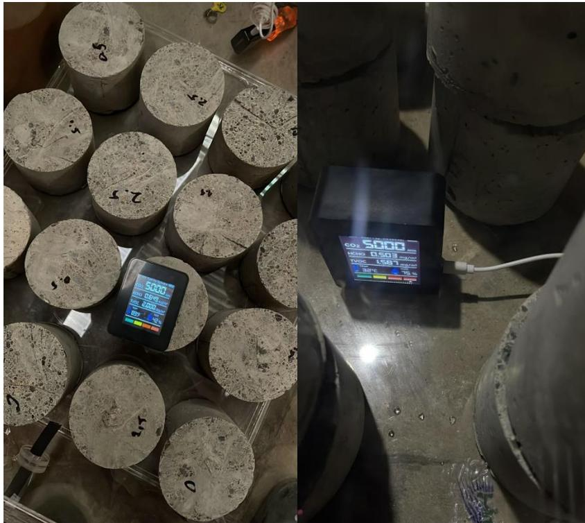
Fotografía 9 Control de medición realizada a especímenes expuestos a dióxido de carbono
