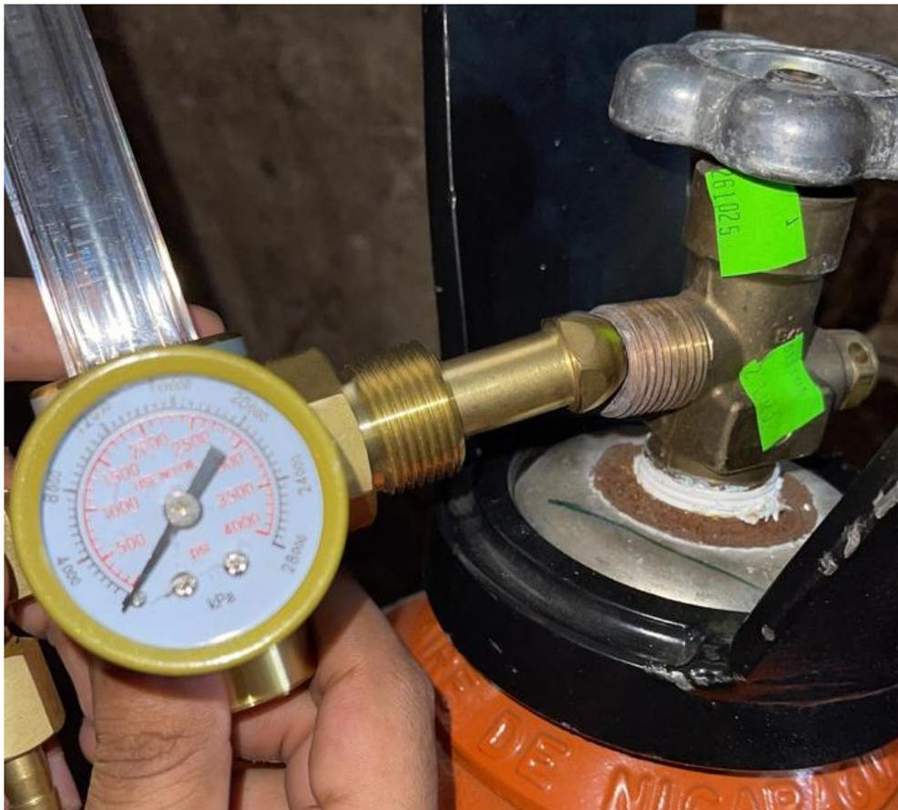
Figura 11. Manómetro utilizado para la regulación de dióxido de carbono (Fuente: Propia).
