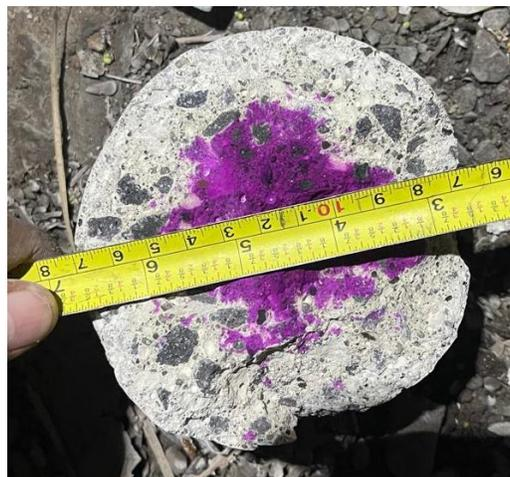
Figura 13. Medición del frente de carbonatación (Fuente: Propia).
