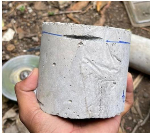
Figura 12. Corte transversal realizado para las probetas expuestas a dióxido de carbono (Fuente: Propia).
