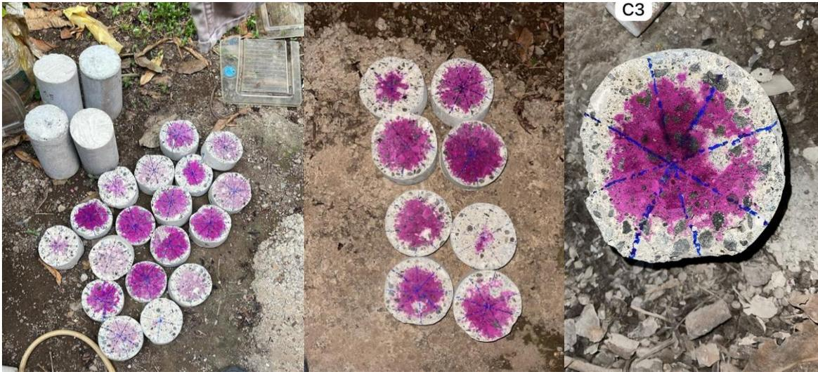
Fotografía 11 Titulación con fenolftaleína realizada a especímenes con diferentes concentraciones de dióxido de titanio
