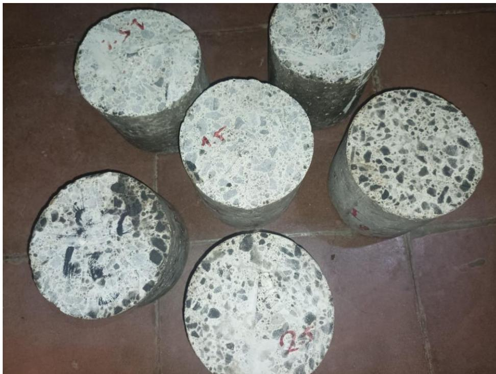
Fotografía 8 Corte transversal realizado a especímenes
