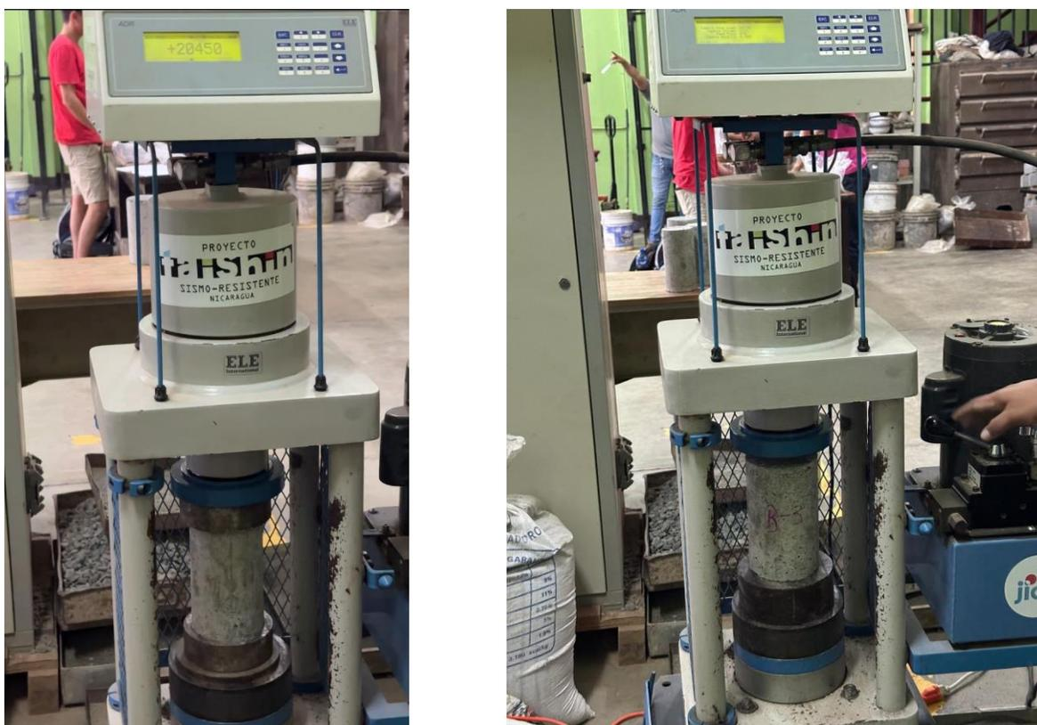
Figura 7. Ensayes de la prueba a compresión Axial (Fuente: Propia).
