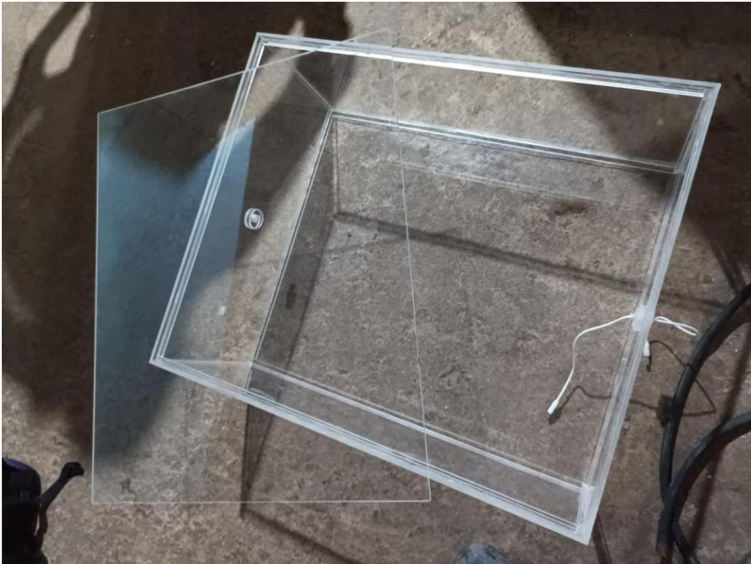
Figura 9. Espacio hermético y controlado donde se llevó a cabo la prueba de carbonatación acelerada (Fuente: Propia).
