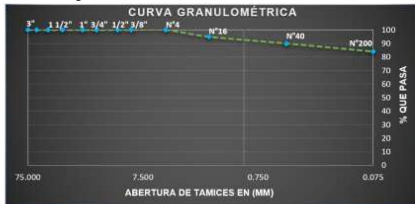
Figura 42: Curva granulométrica sondeo1, estrato 3.
