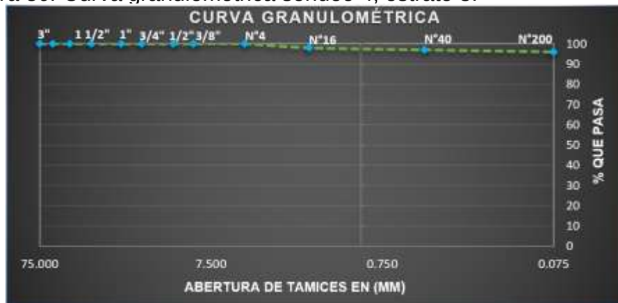
Figura 50: Curva granulométrica sondeo 4, estrato 3.
