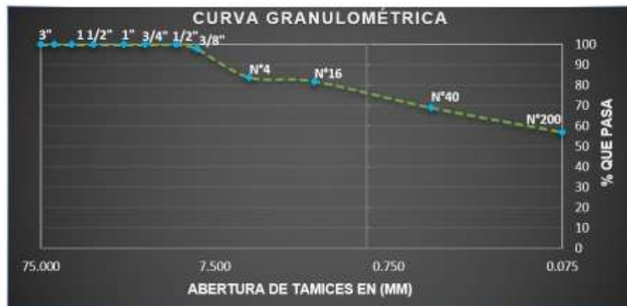
Figura 45: Curva granulométrica sondeo 2, estrato 3.
