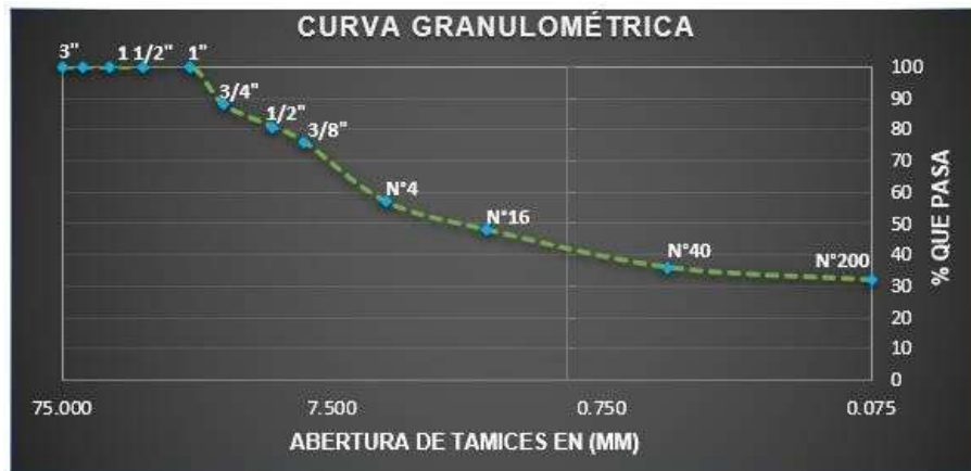
Figura 49: Curva granulométrica sondeo 4, estrato 2.
