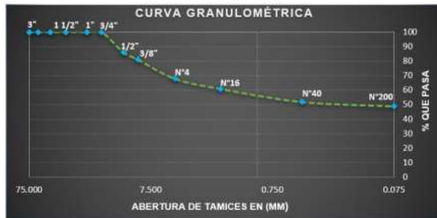
Figura 47: Curva granulométrica sondeo 3, estrato 2.
