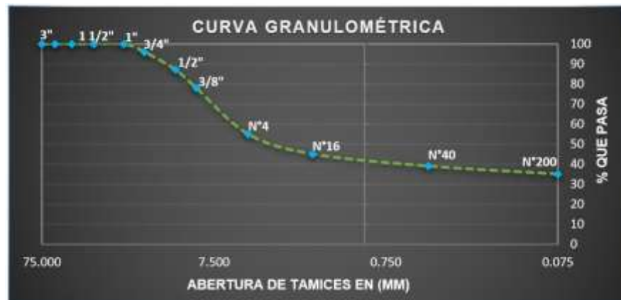
Figura 41: Curva granulométrica sondeo1, estrato 2.
