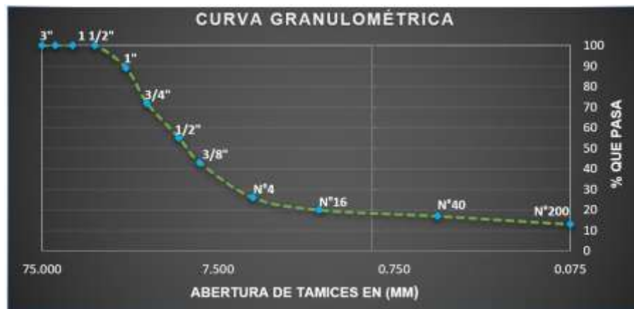
Figura 48: Curva granulométrica sondeo 4, estrato 1.
