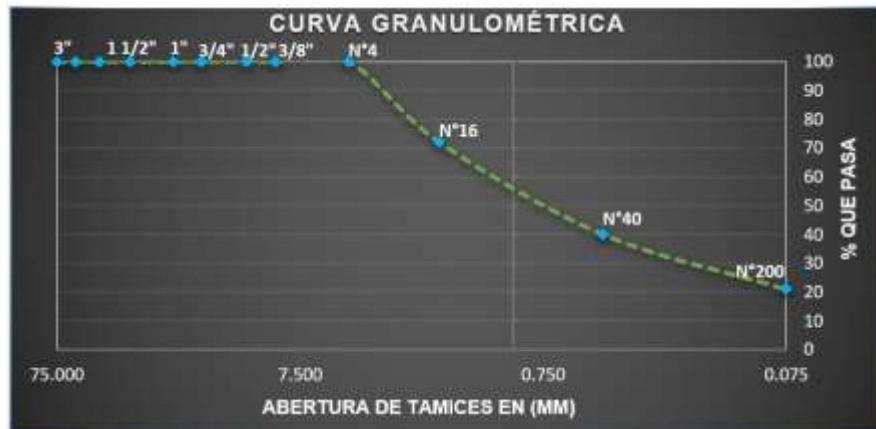
Figura 44: Curva granulométrica sondeo 2, estrato 2.
