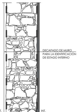
DECAPADO DE MURO PARA LA IDENTIFICACIÓN DE ESTADO INTERNO
