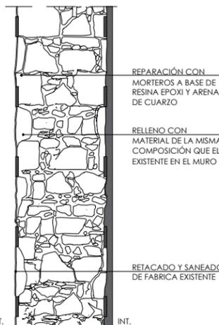
REPARACIÓN CON MORTEROS A BASE DE RESINA EPOXI Y ARENA DE CUARZO
