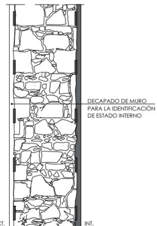
DECAPADO DE MURO PARA LA IDENTIFICACIÓN DE ESTADO INTERNO
