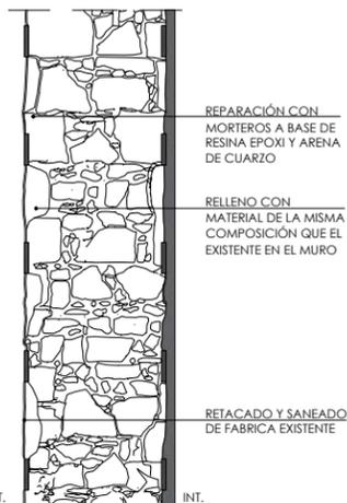
REPARACIÓN CON MORTEROS A BASE DE RESINA EPOXI Y ARENA DE CUARZO
