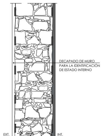
DECAPADO DE MURO PARA LA IDENTIFICACIÓN DE ESTADO INTERNO
