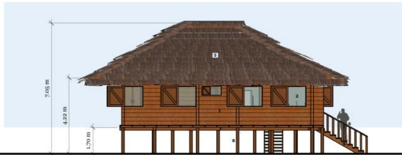
02 LEFT LATERAL ELEVATION | Elevación Lateral Izquierda.
