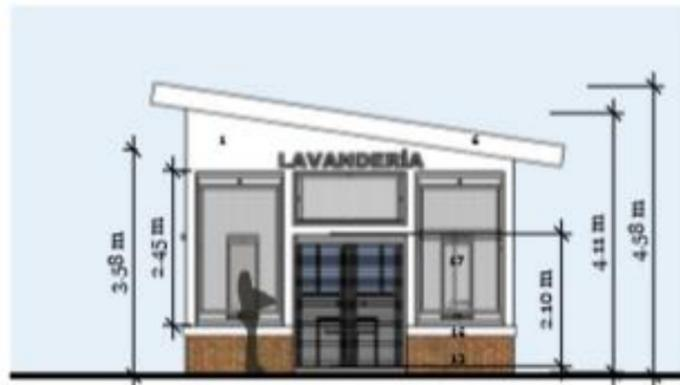
**01** ELEVACIÓN FRONTAL / Front Elevation.
