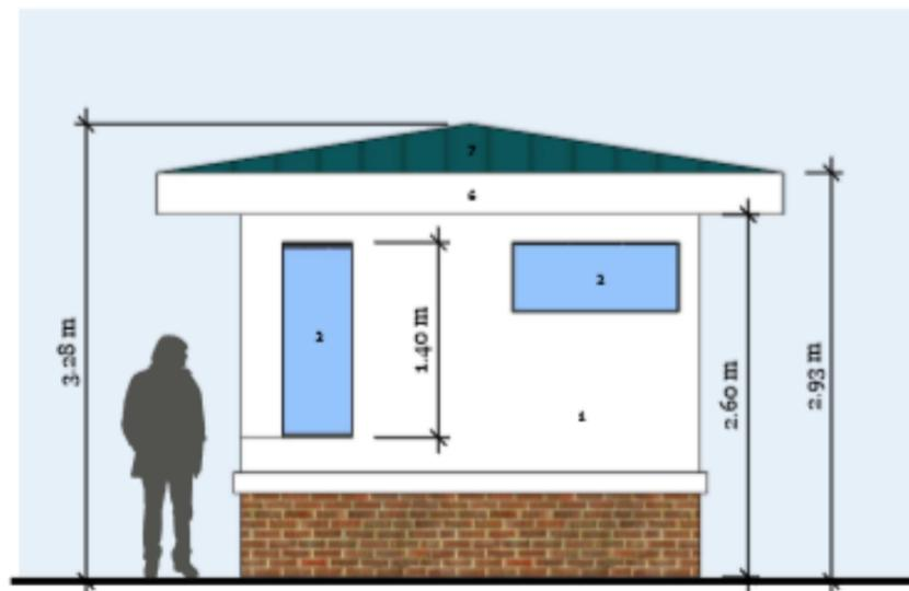
**03** ELEVACIÓN LATERAL IZQUIERDA / Left Lateral Elevation.
