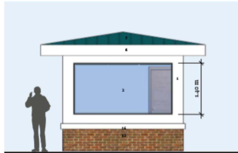
**02** ELEVACIÓN TRASERA / Rear Elevation.
