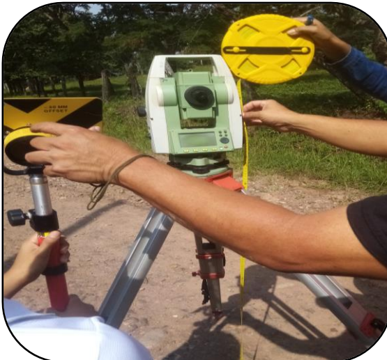
Foto 11. Trípode de aluminio, prisma y cinta.
