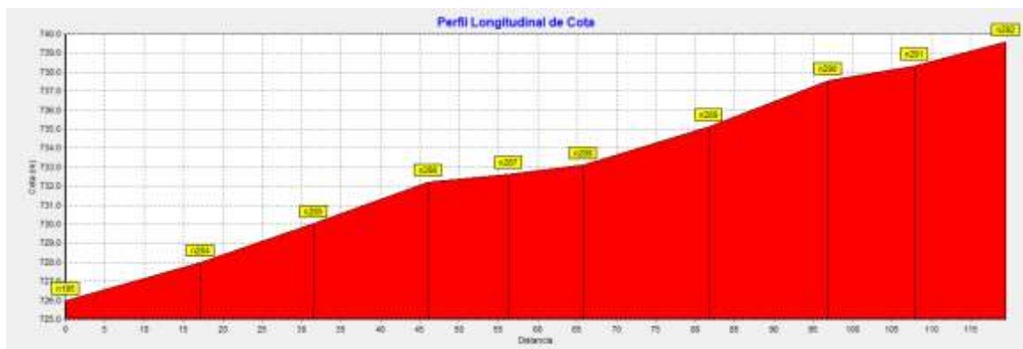
Ilustración 46. Perfil del terreno natural (Tramo # 10)
