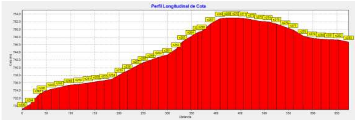
Ilustración 42. Perfil del terreno natural (Tramo # 9)
