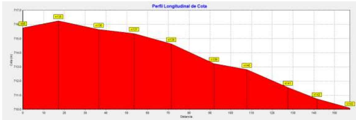
Ilustración 22. Perfil del terreno natural (Tramo # 4)
