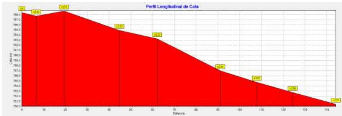
Ilustración 54. Perfil del terreno natural (Tramo # 12)
