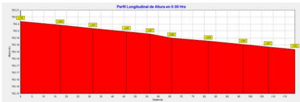
Ilustración 47. Perfil altura piezométrica de la red de distribución (Tramo # 10)
