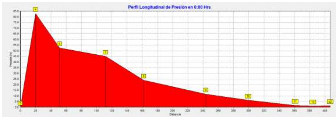
Ilustración 8. Perfil de presiones de la línea de conducción por bombeo
