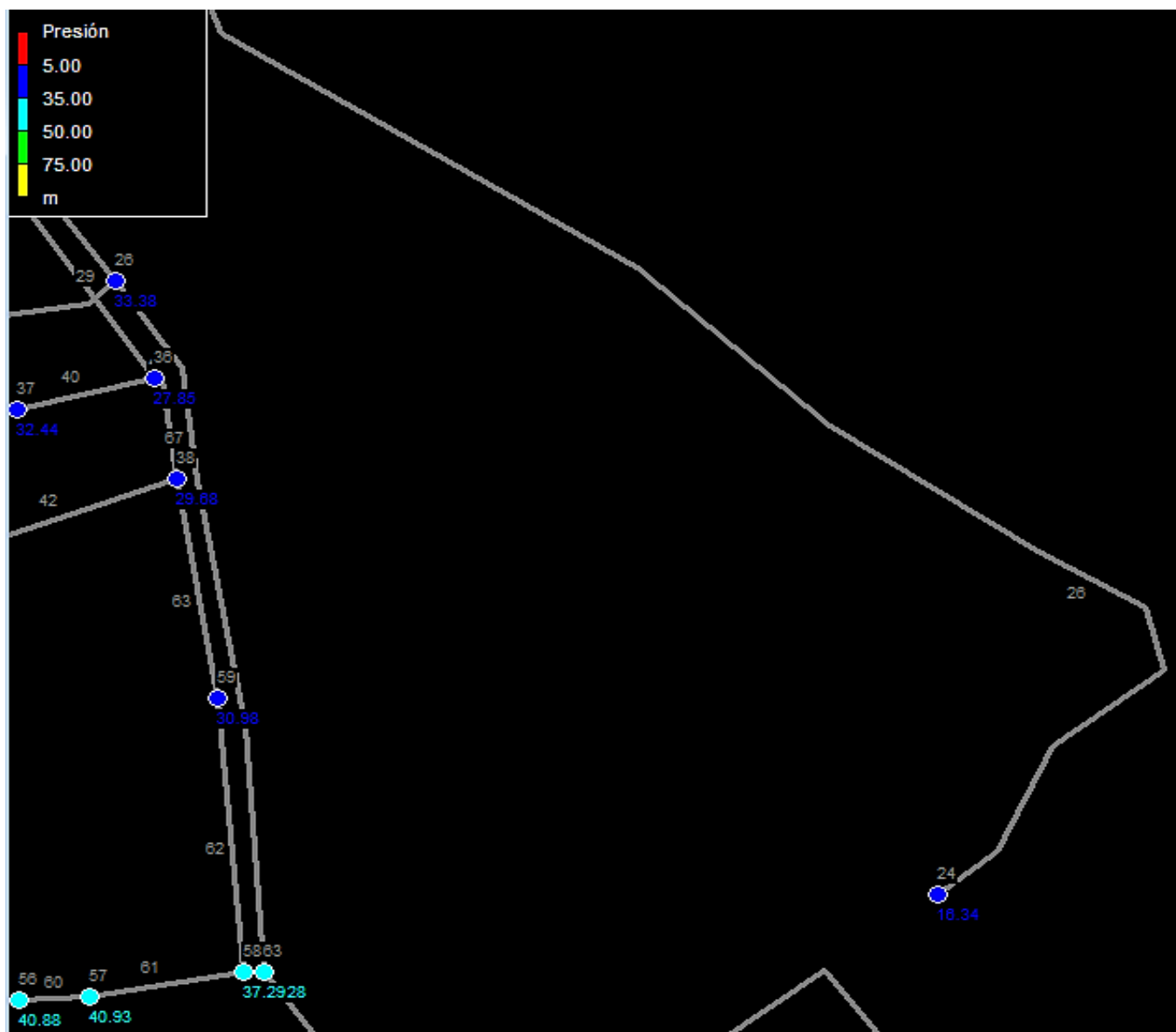
Figura 14 Condición de CMH con tanque lleno (Parte inferior derecha)
