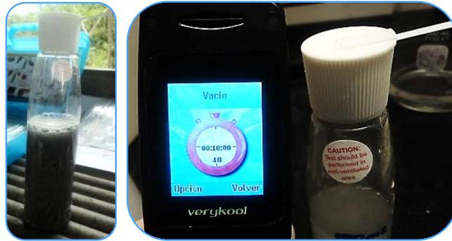
8. Con la ayuda de un cronómetro mida un tiempo de reacción de 10 minutos, en los cuales la reacción se llevará a cabo sin ningún disturbio y en un lugar muy ventilado como una medida de precaución ante las burbujas de hidrógeno que se forman.
