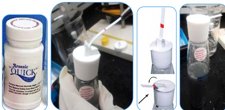
7. Retire una tira reactiva de prueba de arsénico del frasco de tiras de prueba y vuelva a tapar inmediatamente el frasco de tiras reactivas. Para obtener resultados precisos la tira de prueba debe ser orientada e insertada a la profundidad correcta. Inserte la tira reactiva en la perilla a como se ilustra en la figura.
