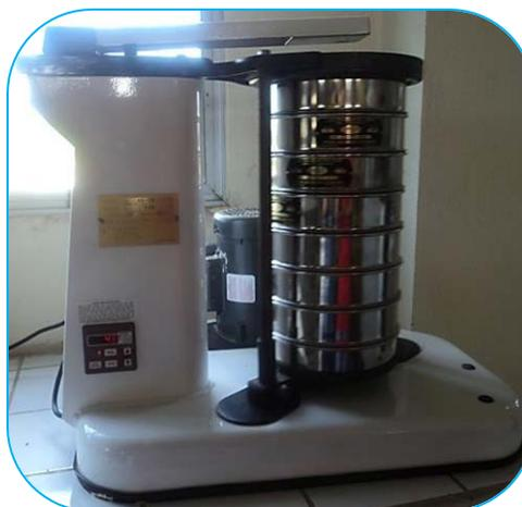
**Figura F.4.** Juego de tamices montado en el agitador mecánico.
