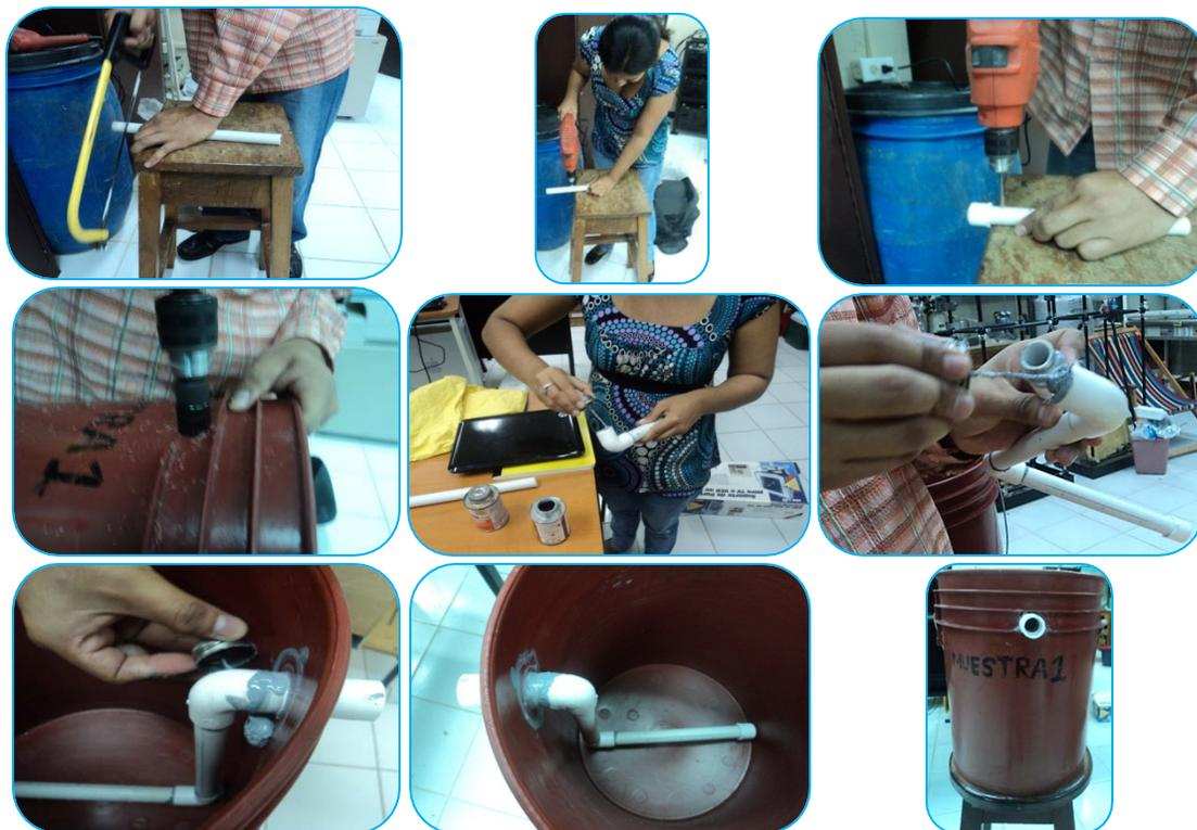
Figura C.6. Construcción de la tubería de PVC para el FMADT.
