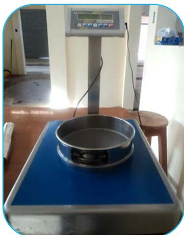
**Figura F.3.** Momento del pesado en forma individual del tamiz N° 12 antes del análisis por tamizado mecánico.
