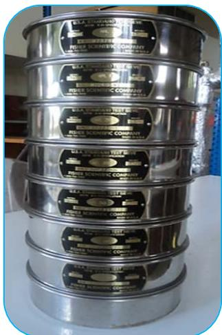
**Figura F.1.** Juego de tamices FISHER SCIENTIFIC del LOU utilizado en el análisis granulométrico de la arena de río Telica por tamizado mecánico.
