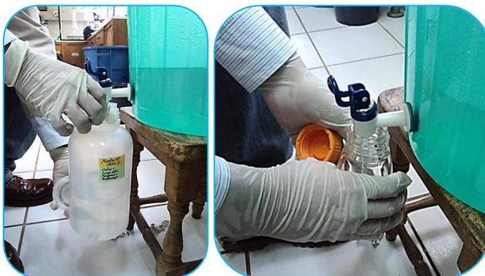
**Figura 4.13.** Recolección de las muestras fisicoquímicas en el PRM-3 en frascos de plástico y vidrio.
