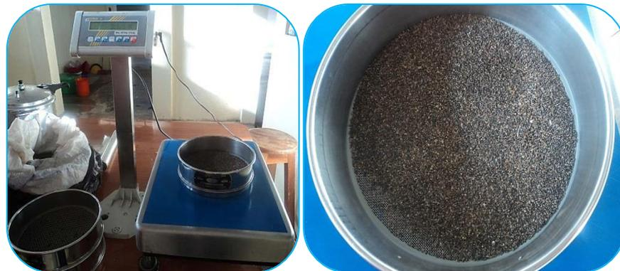
**Figura F.6.** Ejemplo de la determinación de la masa de la fracción de tamaño de partícula retenida en el tamiz N° 20.
