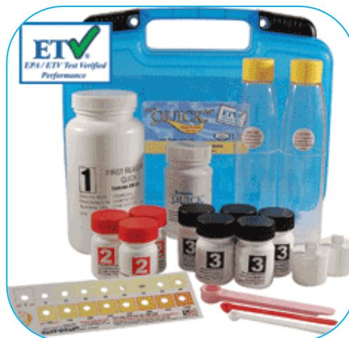
**Figura D.2.** Componentes y accesorios del Quick™ Arsenic Test Kit System.
