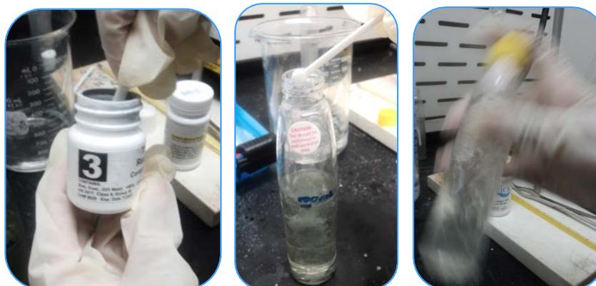
5. Destape al frasco de reacción y agregue 3 *cucharadas* a nivel del 3<sup>er</sup> reactivo, usando la *cuchara blanca*. Asegúrese que el frasco este bien cerrada con el tapón amarillo de mezcla y proceda a agitar vigorosamente por 5 segundos.
