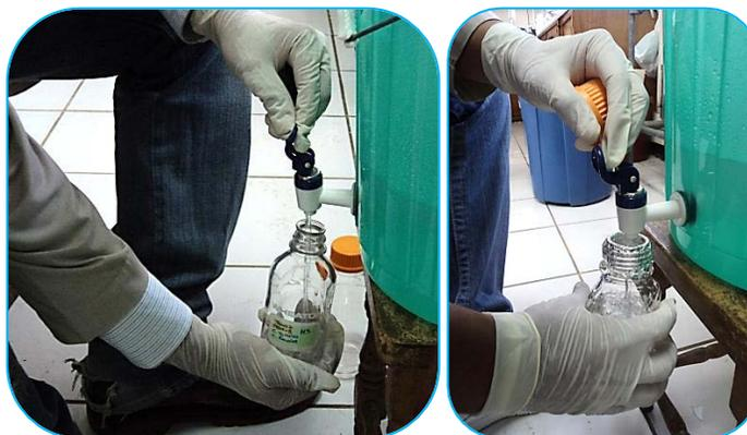
**Figura 4.12.** Recolección de las muestras microbiológicas del agua filtrada por el ST en el PRM-3 en frascos de vidrio.
