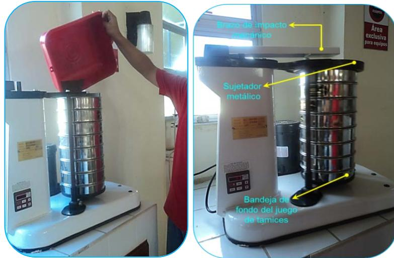
**Figura F.5.** Carga de la masa de muestra al tamiz superior de la serie de tamices y preparación final del agitador mecánico.
