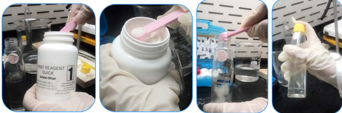
3. Adicione al frasco de reacción 3 *cucharadas* a nivel del 1<sup>er</sup> reactivo, utilizando la *cuchara rosada*. Tape el frasco cuidadosamente con el tapón amarillo de mezcla y agite vigorosamente por 15 segundos.
