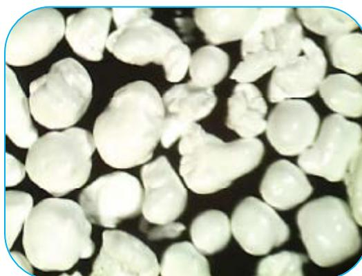
Figura B.12. Aspecto físico del TiO<sub>2</sub> granular de Adsorbsia™ As500.
