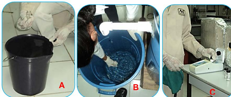
**Figura 4.4.** Monitoreo de la turbiedad de entrada (A), salida (B) y medición (C) durante el proceso de desarrollo de la capa biológica.
