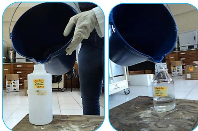
**Figura 4.11.** Método aplicado en la recolección de muestras fisicoquímicas en el PRM-2 (momento preciso del llenado de los frascos de vidrio y plástico).
