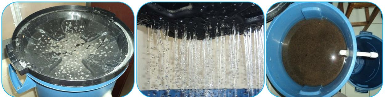
**Figura C.5.** Tapa del recipiente plástico utilizada como difusor y FBA sin difusor.
