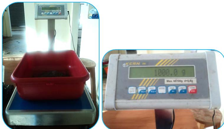
**Figura F.2.** Masa de la muestra de arena de 1000 g para el análisis granulométrico.
