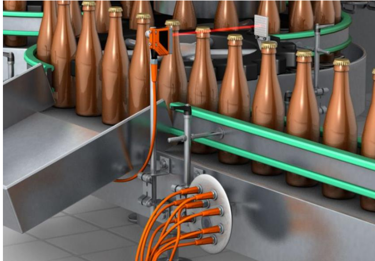
Figura 9. Sensor fotoeléctrico IFM para detección de botellas
