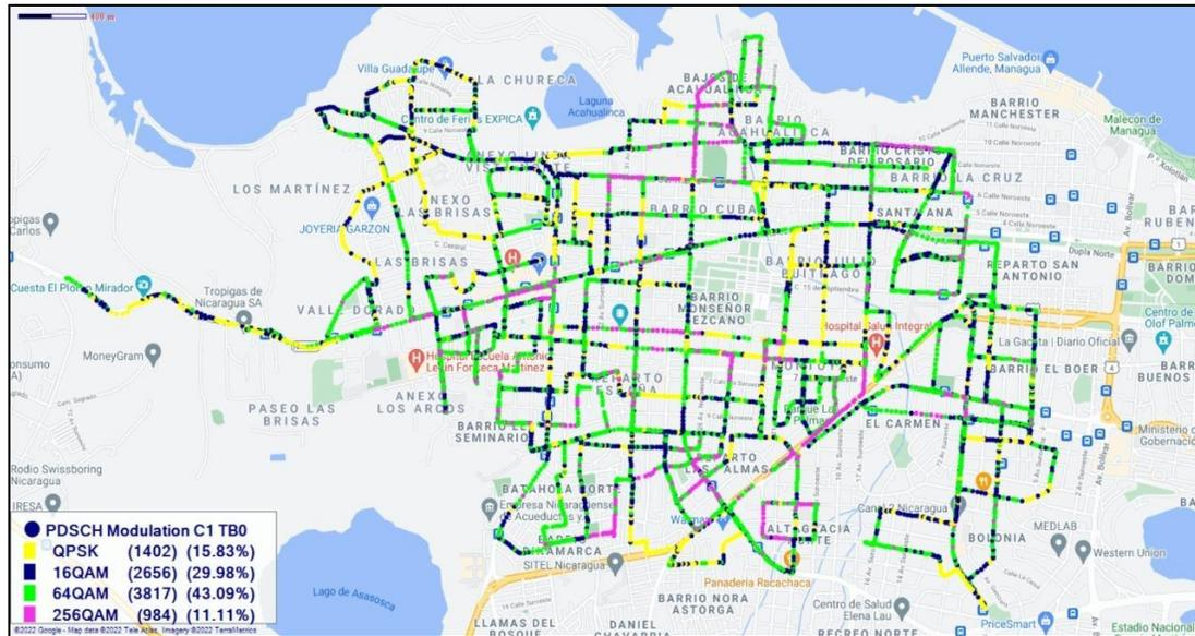
**Figura 33. Esquema de modulación Post.**
