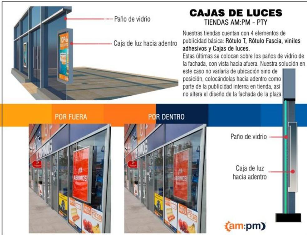
Ilustración 51: Especificaciones cajas de luces
