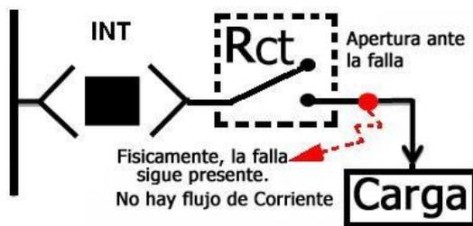
Figura 2.2.c. Se produce la primera acción de desconexión por parte del Rct. En la Ilustración 5. esto corresponde al lapso de tiempo entre los periodos
