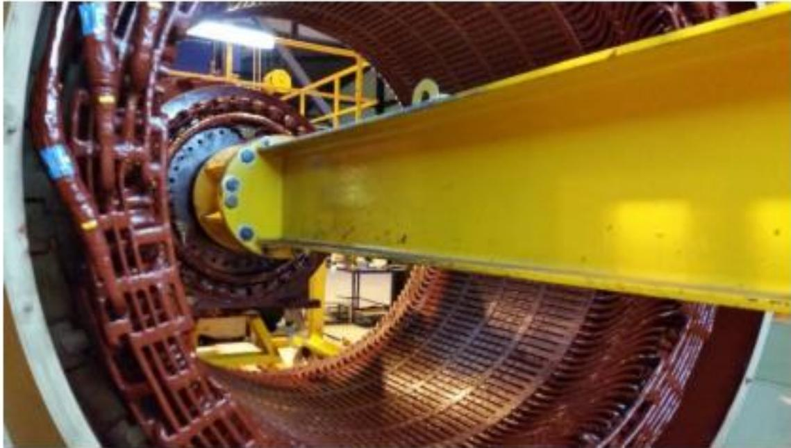
**Proceso de barnizado del estator del generador**
