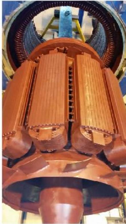
**Proceso de barnizado del Rotor del generador**
