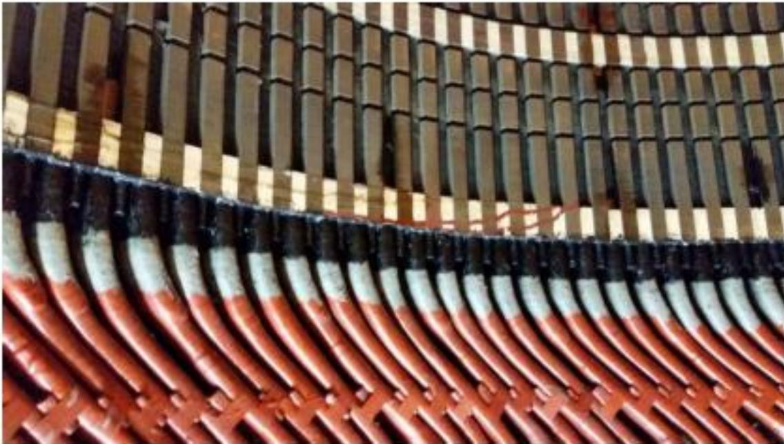
**Aplicación de pintura semiconductora en el estator del generador**
