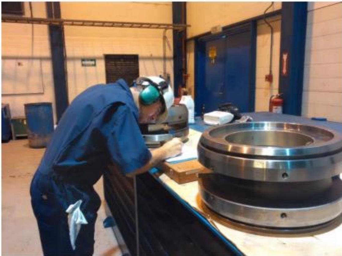
**Medición de los Bearings del generador**
