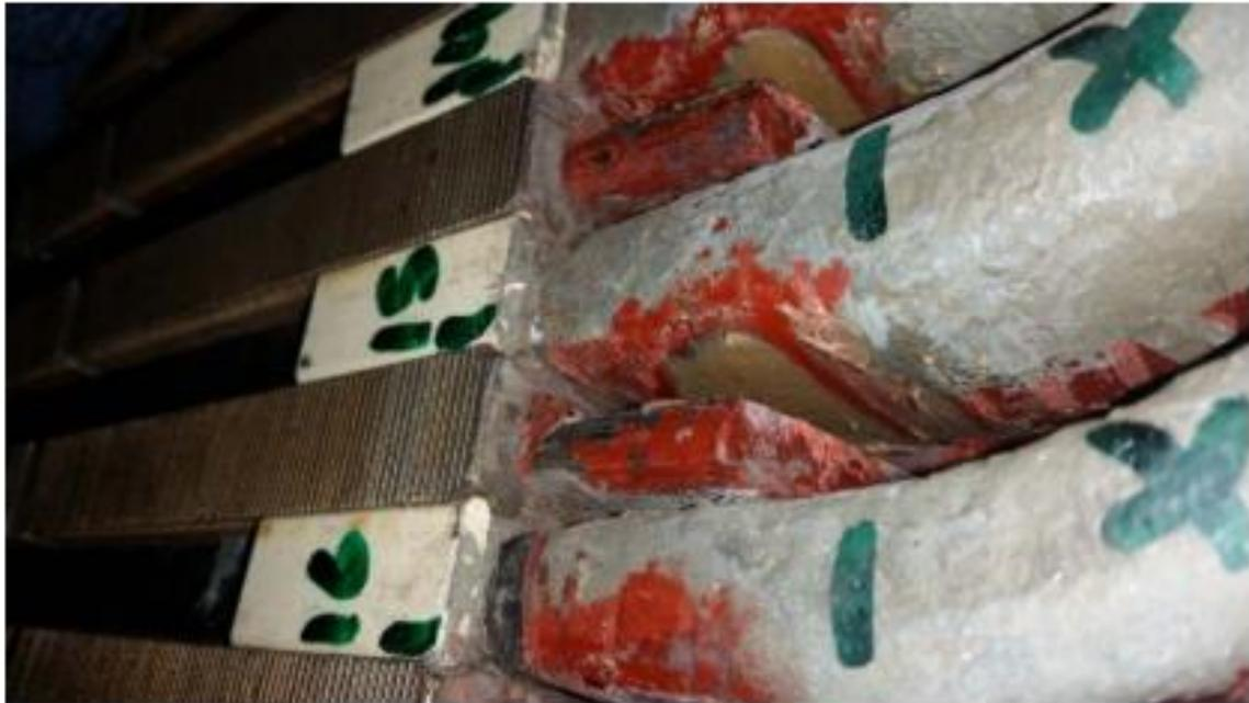
**Recuperación de parte dañada con la aplicación de material aislante especial en devanados y el Fingerplate**
