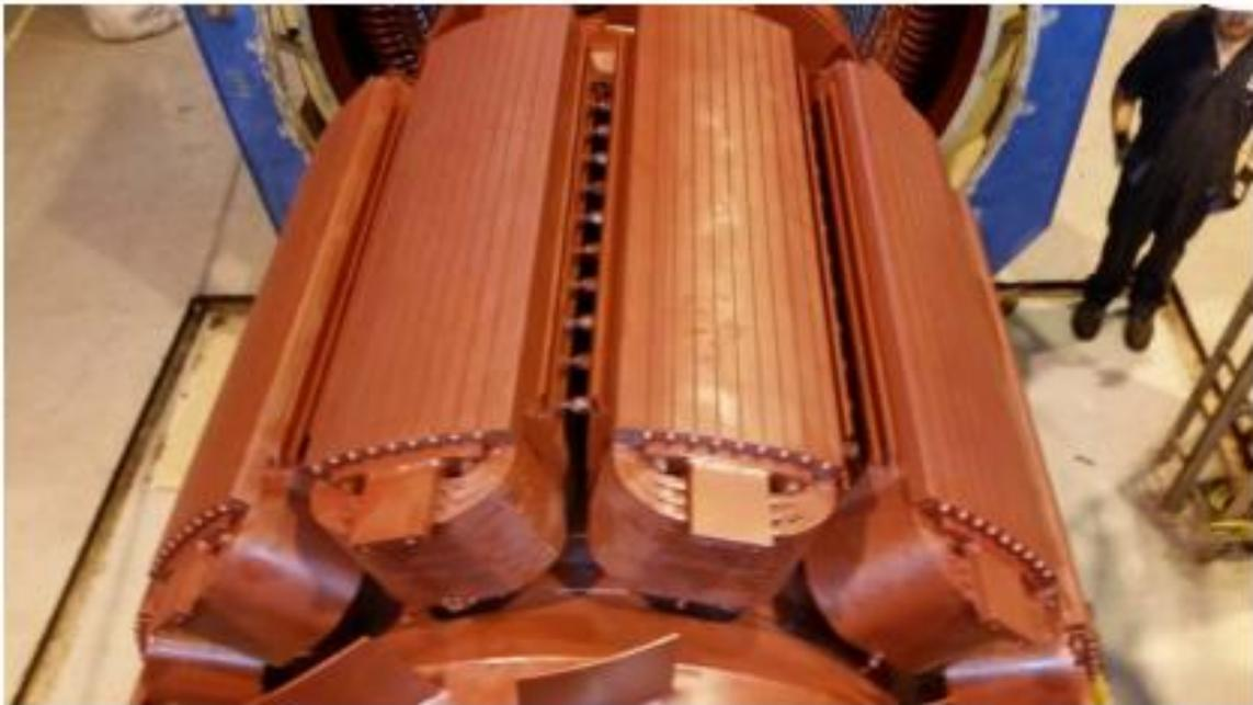
**Proceso de barnizado del Rotor del generador**
