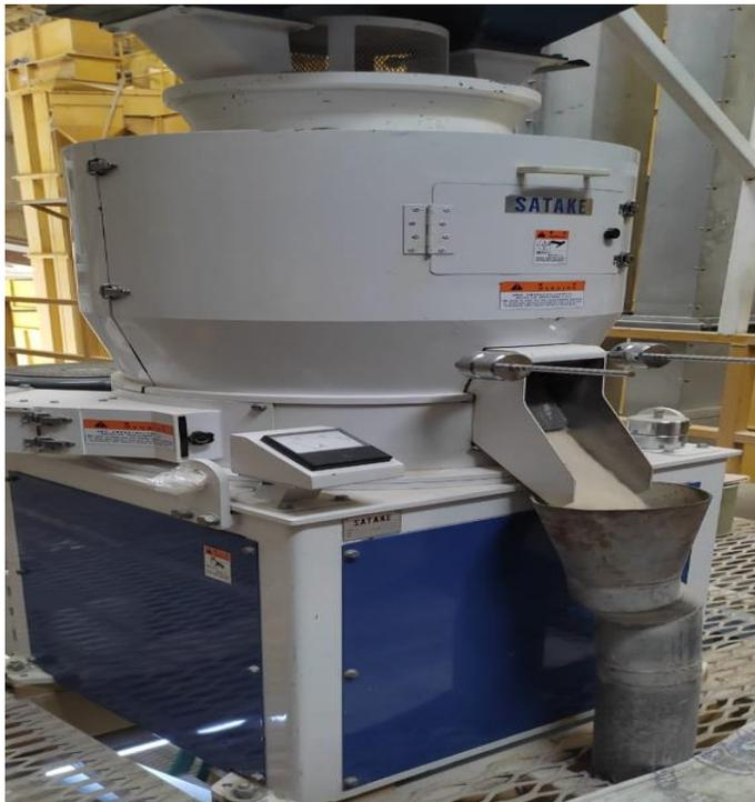
Este pulidor se encarga de blanquear aún más el grano de arroz en su segundo pase a través de fricción y aire.
