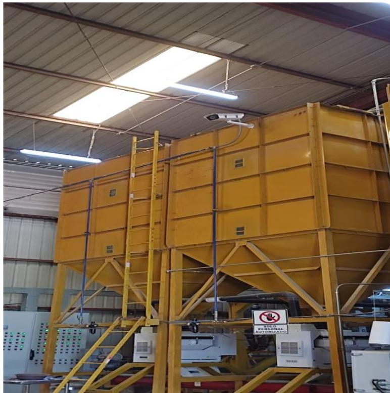
Se encargan de almacenar el arroz entero en una y el arroz quebrado en otra para su debida mezcla en las calidades a empacar
