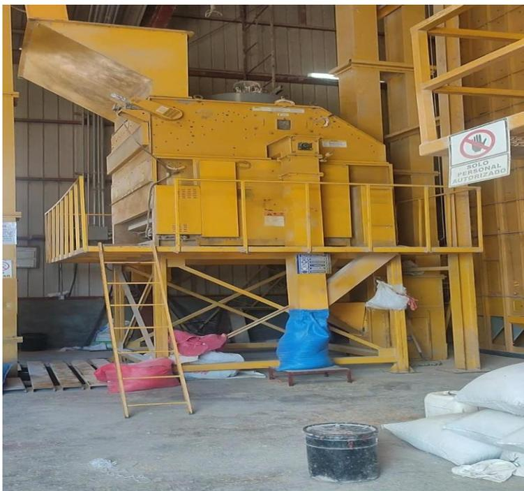
Pre-limpiadora que separa la granza de toda materia extraña que esta contenga, con el fin de evitar la contaminación del producto terminado y el daño de los equipos de procesos posteriores al pre-limpiado.
