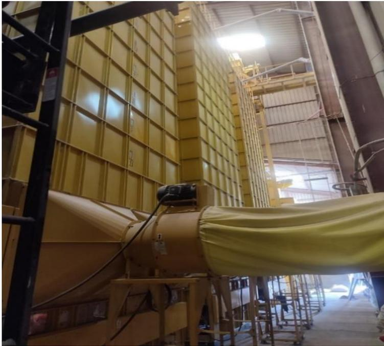
Secadoras con capacidad de 600 qq cada una (6 en total) donde se introduce la granza a 22° de humedad hasta llegar a 13° para procesarse.
