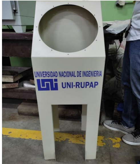
Figura 48: Acabado de pulido y pintado en carcasa (fuente propia).
