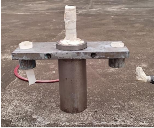
Figura 43: Enmascarado previo a aplicar capas de acabado cabezal de compresión (fuente propia)
