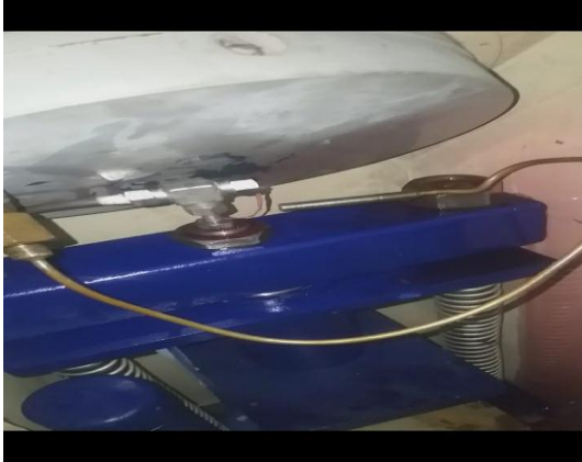
Figura 32: Acoples y accesorios hacia la válvula de distribución. (fuente propia)
