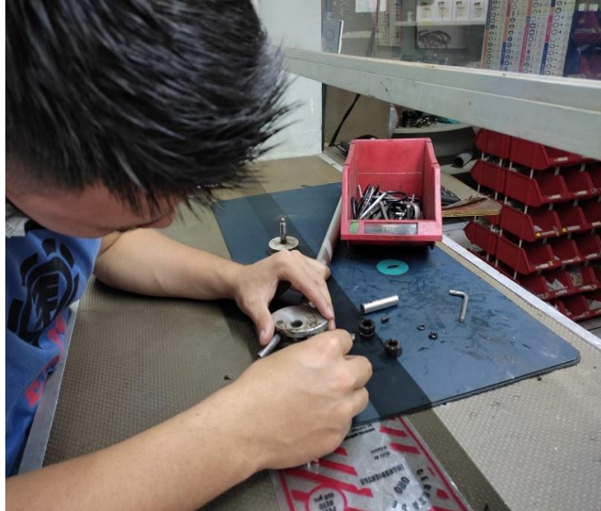
Figura 23: Desmontaje de sellos hidráulicos en pistones de la válvula de mando (Fuente propia)
