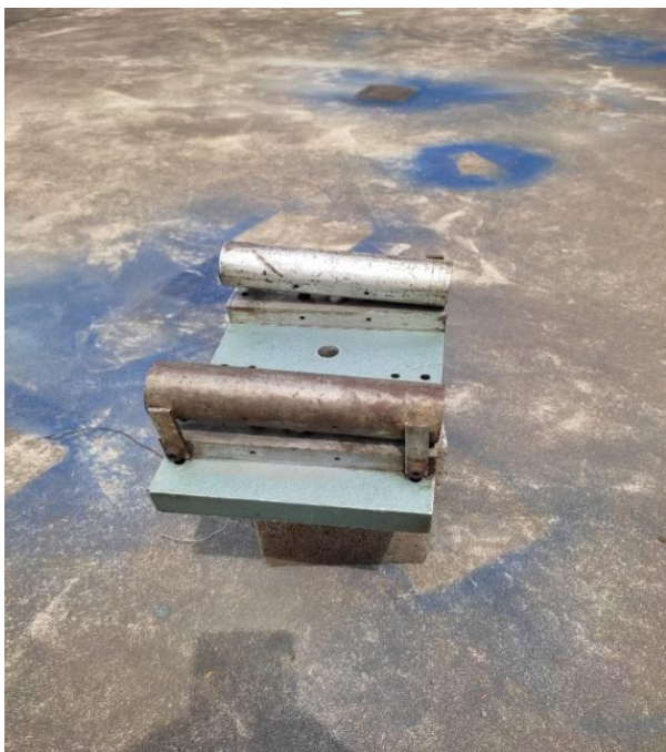
Figura 38: Rodos de apoyo de la placa base desmontados. (fuente propia)
