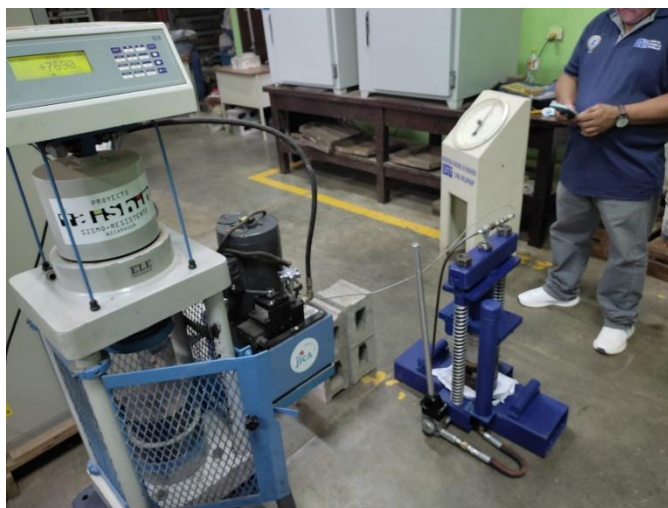
Figura 52: Ensayos comparativos con modulo ADR(fuente propia)
