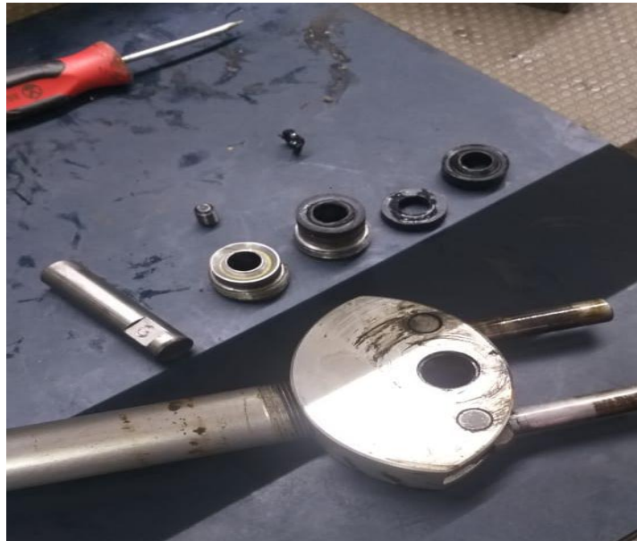
Figura 24: Identificación de sellos hidráulicos en pistones de la válvula de mando (Fuente propia)
