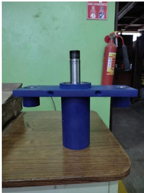
Figura 49: Acabado de pulido y pintado en pistón de compresión. (fuente propia)
