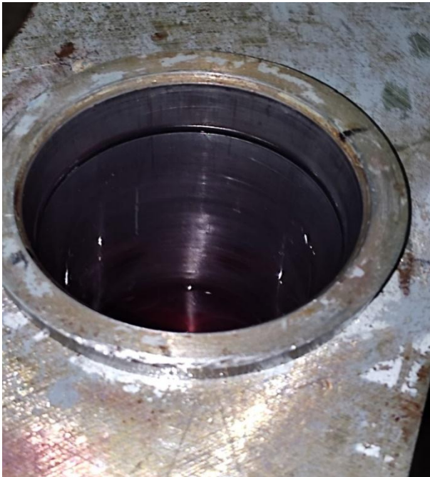
Figura 27: Sello del cilindro de cabezal de compresión. (fuente propia)
