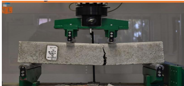
Figura 8: Ensayo de deflexión en viga de concreto rectangular 6x6 pulg con máquina de cuatro puntos de apoyo. ( constructora Dávalos sac)
