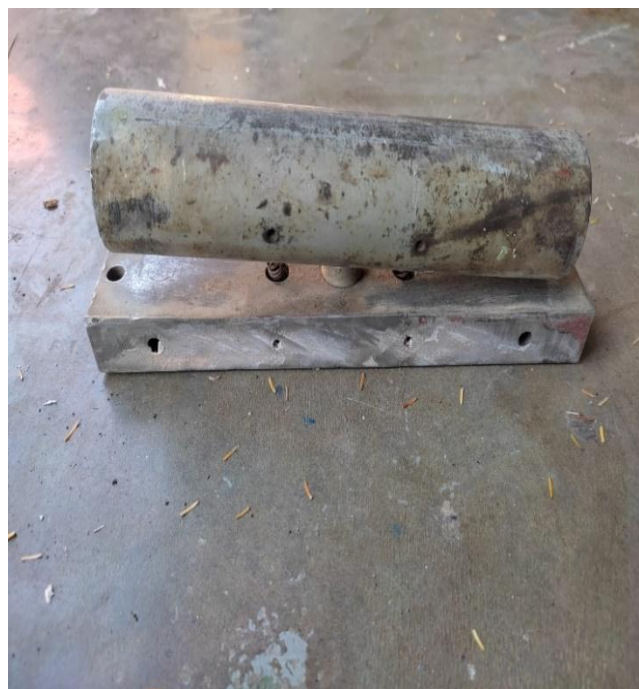
Figura 39: Detalle de rodo de apoyo. (fuente propia)
