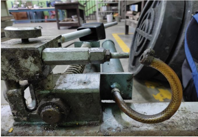
Figura 29: Estado anterior manguera de PVC para alimentación del fluido hidráulico. (fuente propia)
