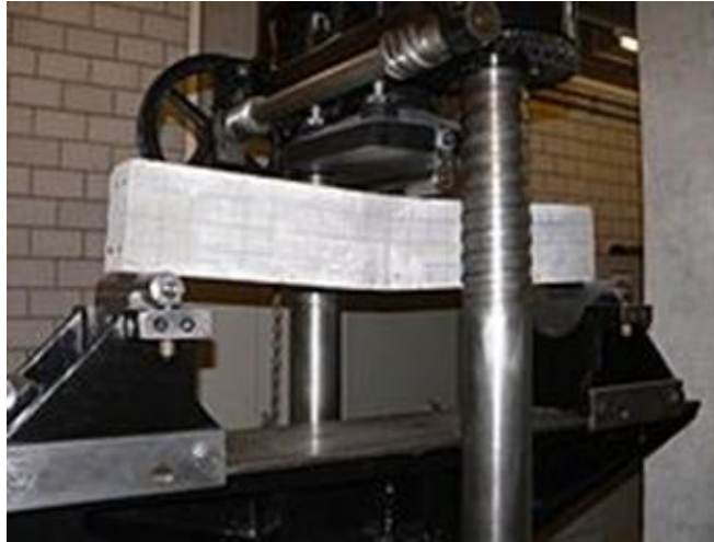
Figura 3: Ensayo de flexión en viga de concreto. (WIKIPEDIA, 2021)
