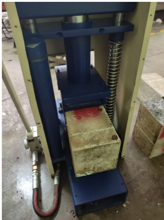
Figura 53: Ensayo de deflexión con vigas de concreto con tres puntos de apoyo (fuente propia)
