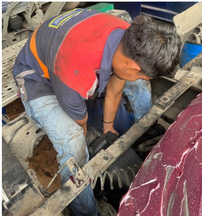
*Figura 20 Mecánico del taller desmontando caja de Transmisión.*
