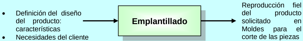
Fig. 7: Entradas y salidas de la etapa de emplantillado
