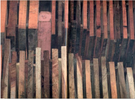
Fig. 5: La madera se encuentra almacenada (enreglado) mientras se seca hasta tener un adecuado grado de humedad y es seleccionada para ser transformada.
