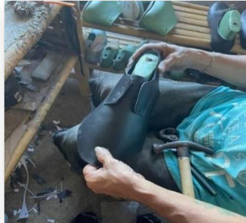
Ilustración 38: Montado en Horma.
