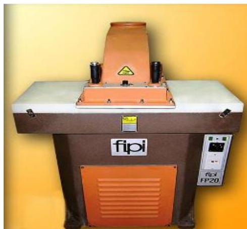
Ilustración 66: Maquina para troquelar calzado
