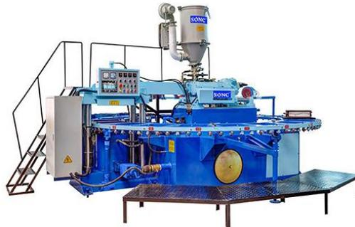
Ilustración 69: Inyectora monocolor para suelas.
