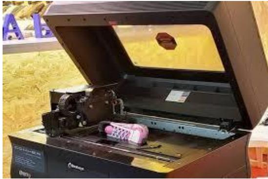
Ilustración 65: Máquina de Impresión 3D.
