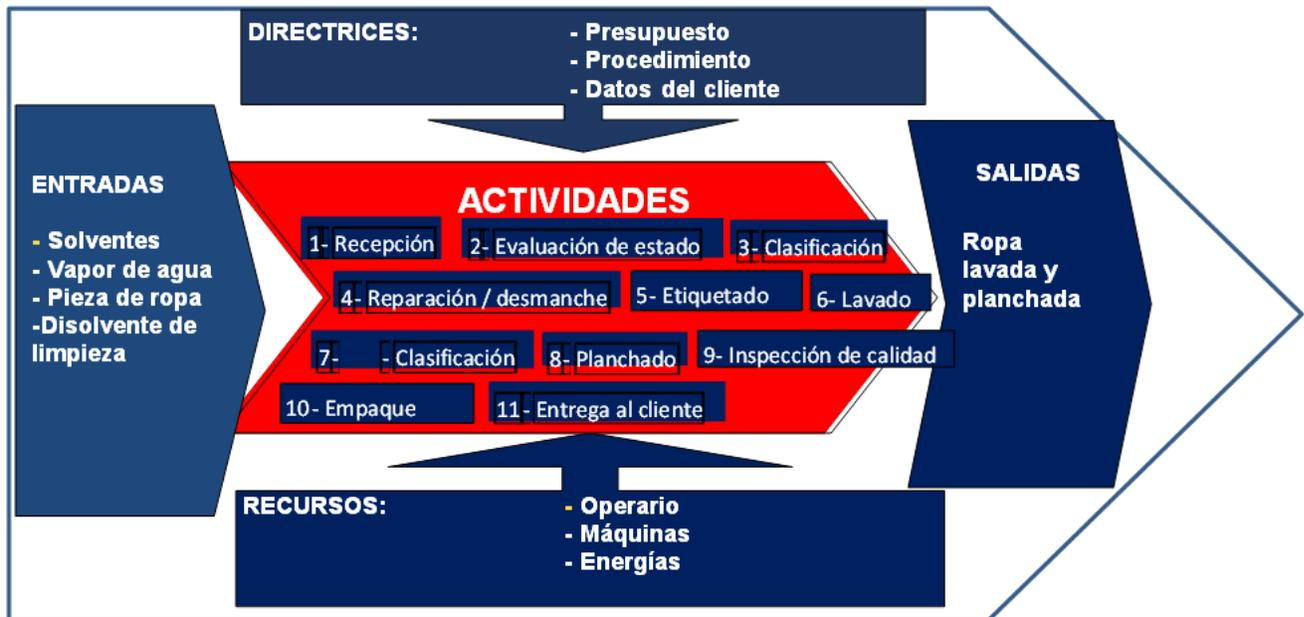
Ilustración 6 Diagrama de proceso del lavado en seco.
