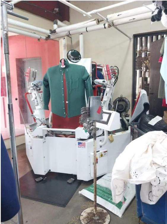
Ilustración 18 Maquina para planchar Hombros y Espalda
