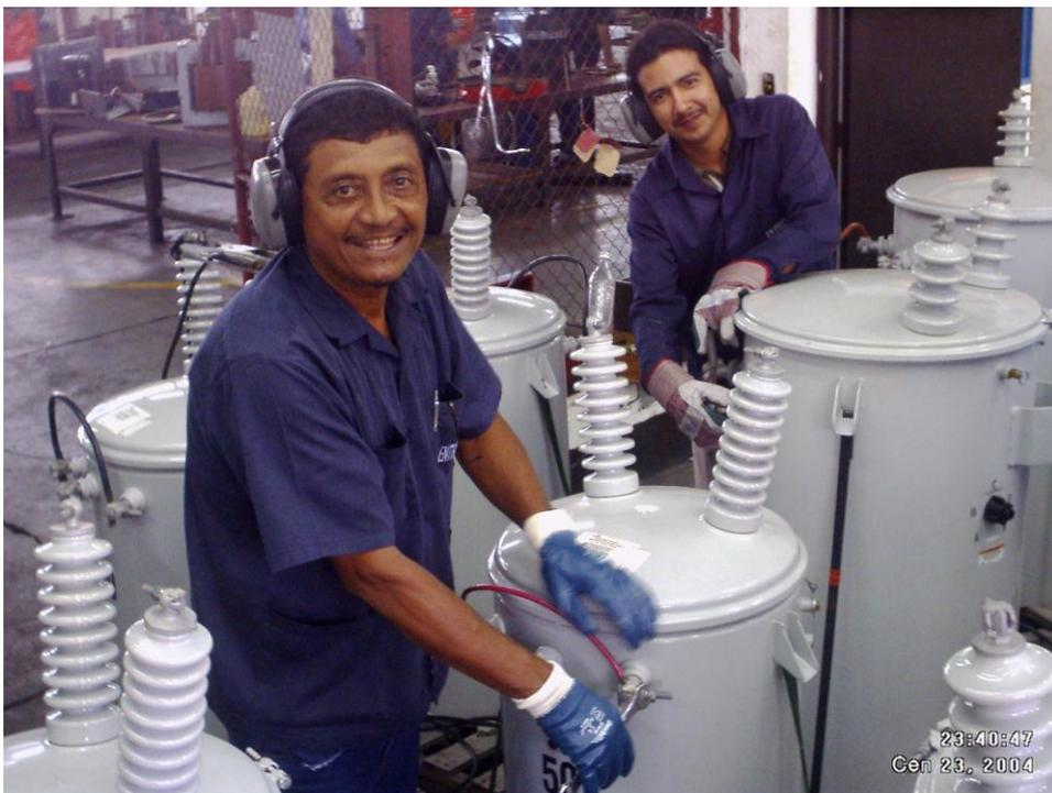
Foto No 1. Transformadores en proceso de inspección.
