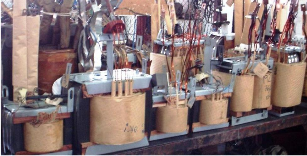
Foto No 5. Transformadores en espera de secado, prueba y montaje.
