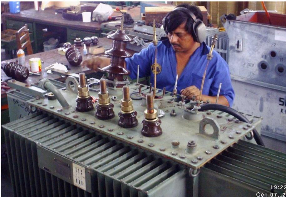
Foto No 3. Transformador de 630 Kva. En reparación..
