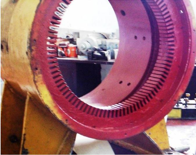
Foto No 9. Excitatriz de generador de 2000Kw en reparación.
