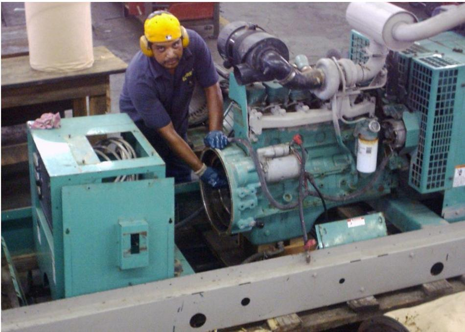
Foto No. 6 Generador con motor diessel en proceso de reparación.
