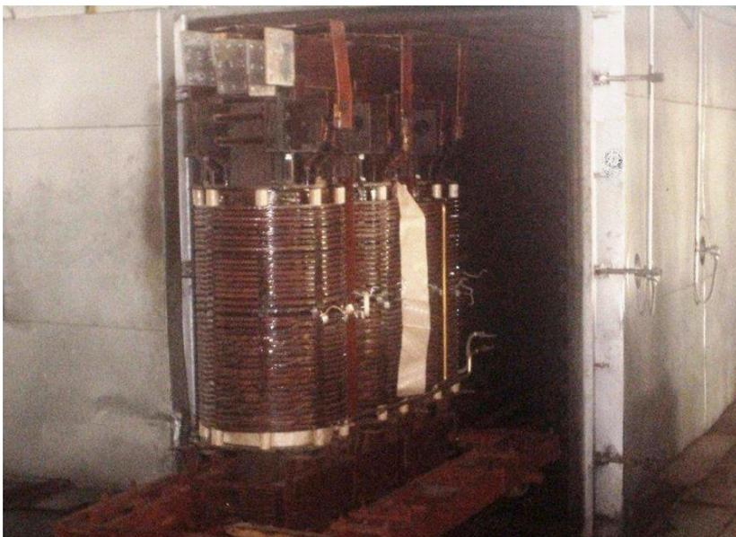
Foto No 2. Transformador de 2500 Kva. a proceso de secado al vacío.
