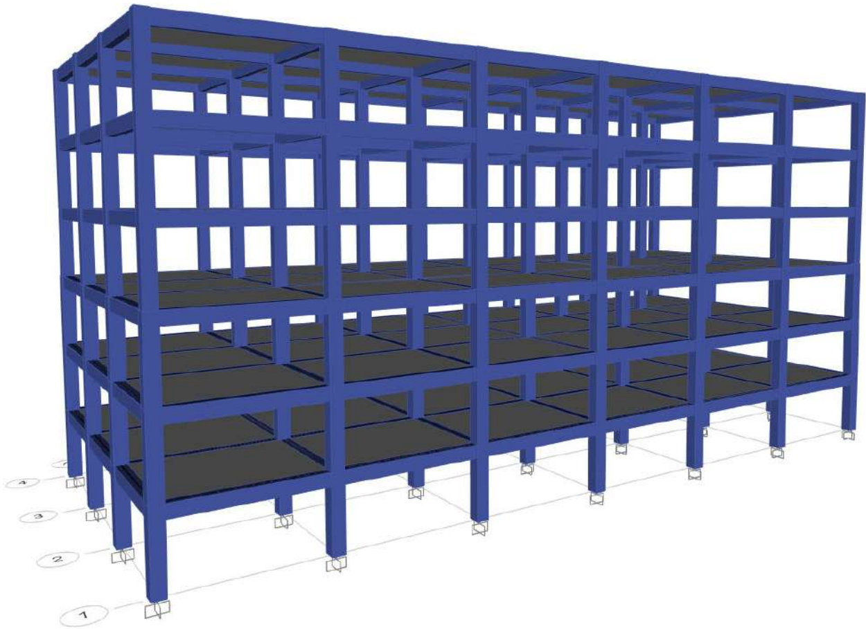
Figura 20 Vista 3D - Modelo estructural
