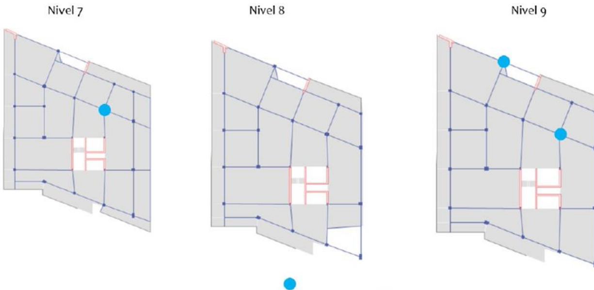
Figura 53. Ubicaciones de columnas a reforzar en los niveles 7 a 9 Fuente: Modelo Estructural – análisis convencional
