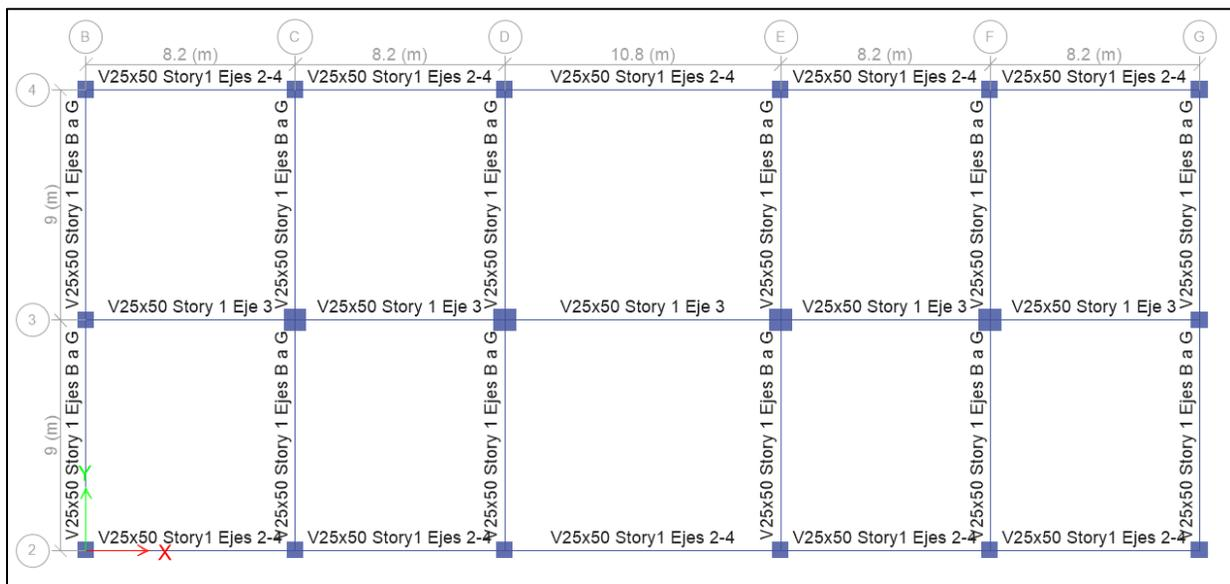
Figura 7.6 Planta vigas y capitel aislamiento sísmico – Propuesta con Aislamiento Sísmico
