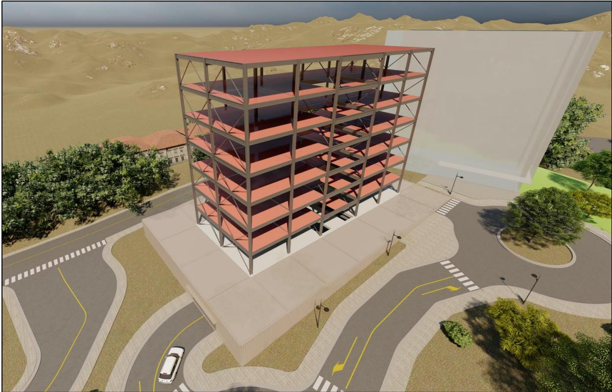
Figura 4.9 Estructuración convencional Sentido X – SMF y Sentido Y - SCBF
