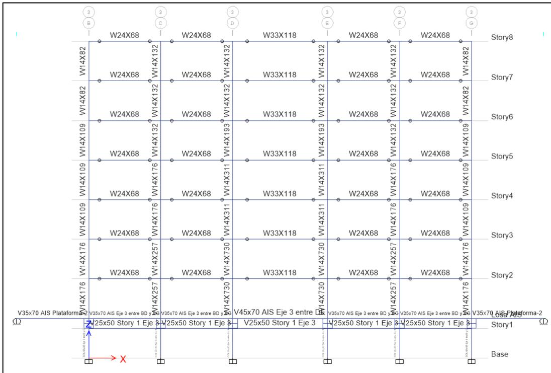
Figura 7.14 Elevación Eje 3 – Propuesta con Aislamiento Sísmico
