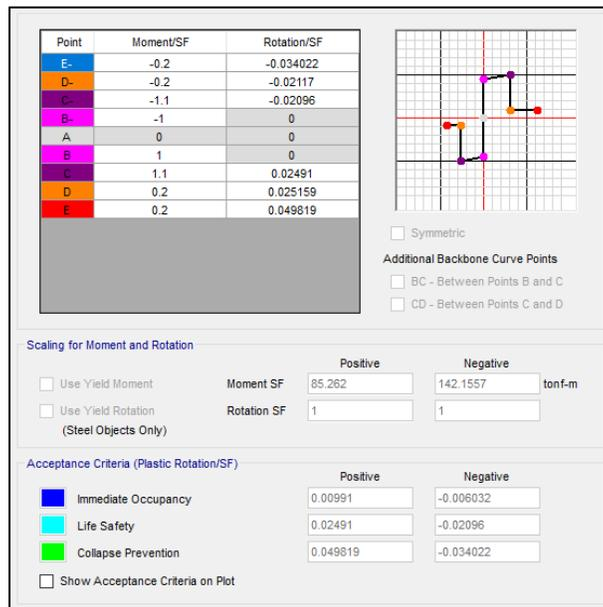
Figura 7.21 Rótula plástica asignada a viga de concreto V45X75 AIS Eje 3 entre DE
