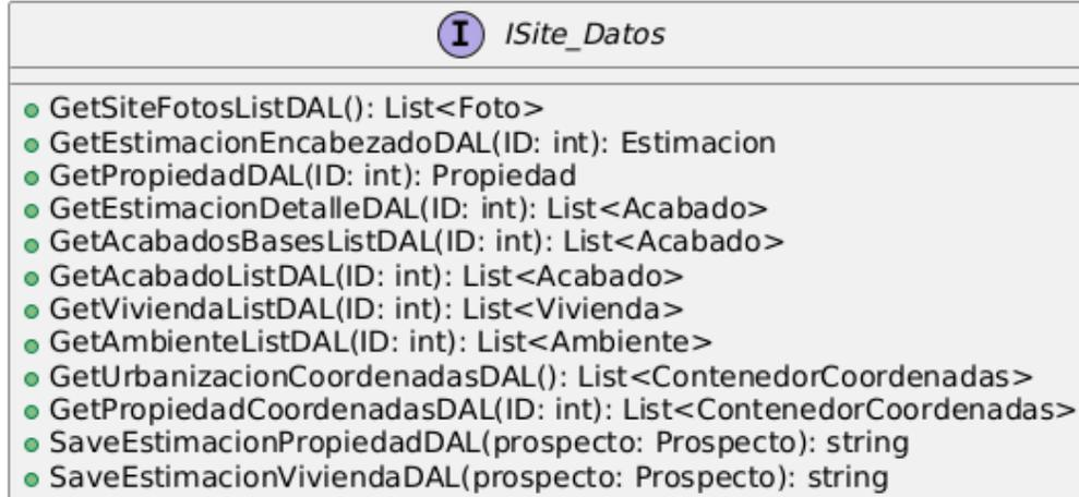
Nota: Ilustración con los métodos de las interfaces para la capa de datos para site.
