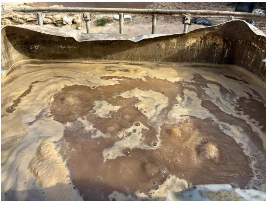
Figura E: Recirculación de solución de cianuro de sodio ( \text{NaCN} )
