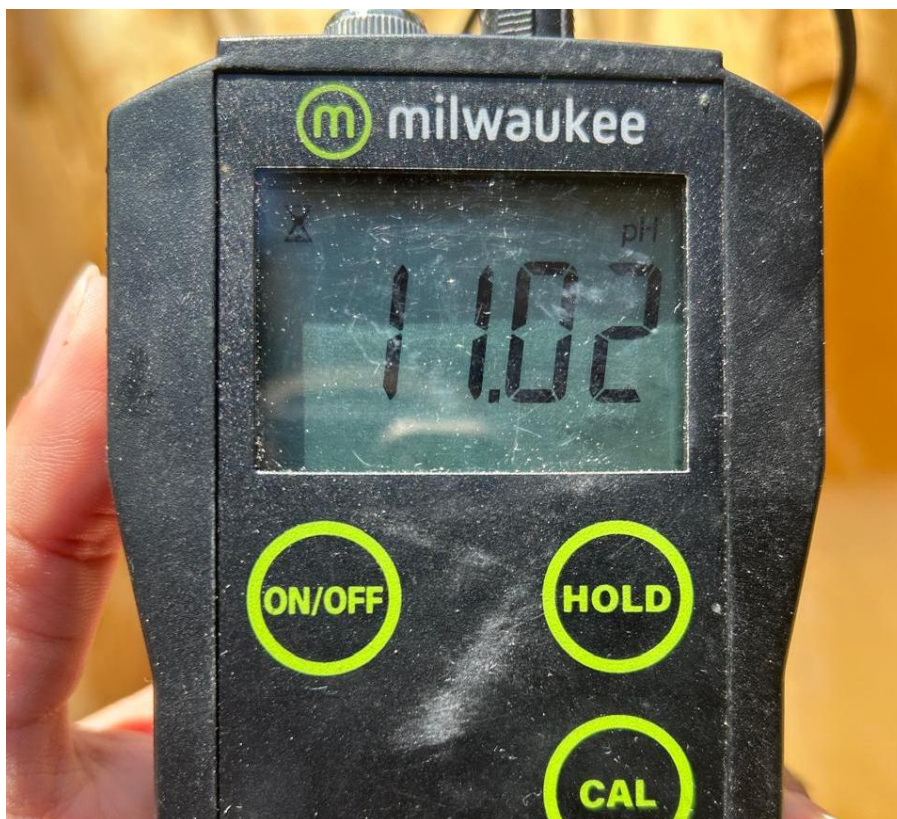
Figura G: Monitoreo de pH con medidor de pH portátil Milwaukee
