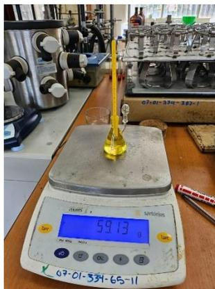
*Nota.* La figura muestra el peso del picnómetro con aceite correspondiente a la segunda medición de la densidad del aceite extraído adicionalmente con hexano al 95 % como disolvente. *Elaboración propia.*
