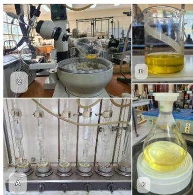
*Nota.* En la figura se muestra las etapas del proceso de extracción: el funcionamiento del extractor Soxhlet (A), la mezcla obtenida tras cuatro horas de extracción (B), la recuperación del solvente mediante el rotavapor (C) y el aceite bruto total obtenido después de evaporar el solvente remanente en el horno (D). Este procedimiento se aplicó en todas las corridas del diseño experimental.
