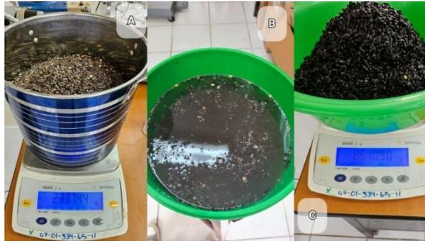
*Nota.* La figura presenta el peso total de las semillas utilizadas para evaluar los ocho tratamientos (A), el proceso de limpieza por inmersión (B) y el peso de las semillas húmedas después del proceso de limpieza (C). *Elaboración propia.*
