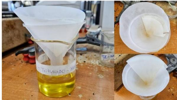
*Nota.* La figura muestra el sistema de filtrado empleado para refinar el aceite de semilla de maracuyá. Este procedimiento se aplicó en todas las corridas del diseño experimental. *Elaboración propia.*
