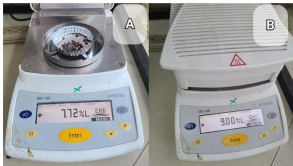
*Nota.* La figura presenta el contenido de humedad de las semillas después del proceso de secado a 60°C durante 4 horas (A) y a 40°C durante 12 horas (B). *Elaboración propia.*
