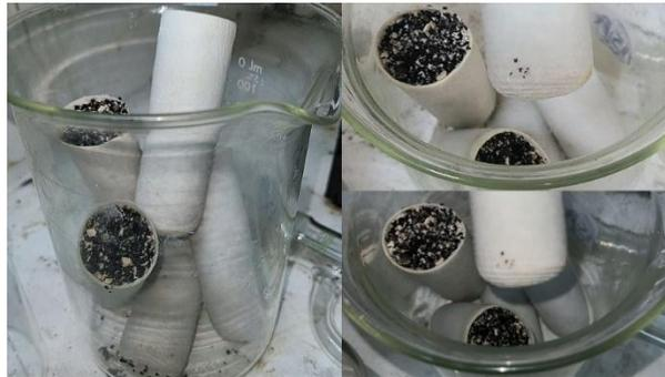
*Nota.* La figura muestra la harina residual de extracción, que corresponde a la masa de semillas con solvente remanente retenida en el cartucho de extracción de extracción al finalizar el proceso. *Elaboración propia.*
