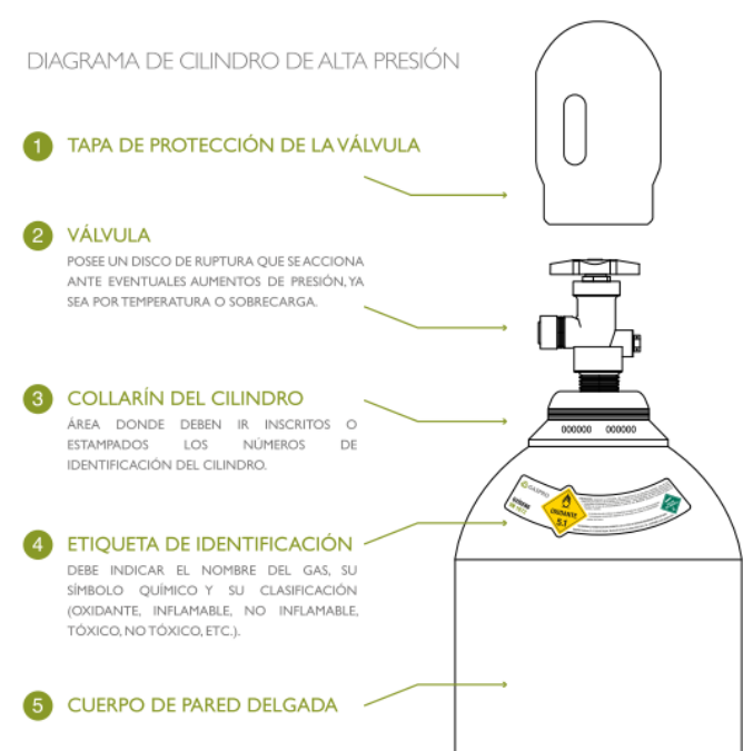
Figura 17: Diagrama de un Cilindro de Alta Presión.
