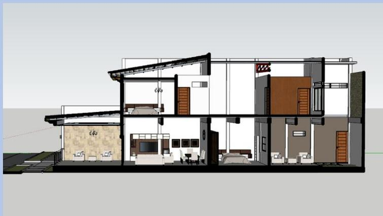
*Ilustración 58. Modelado 3D Corte Longitudinal. Estudio Arq. Ernesto Castillo 2022*
